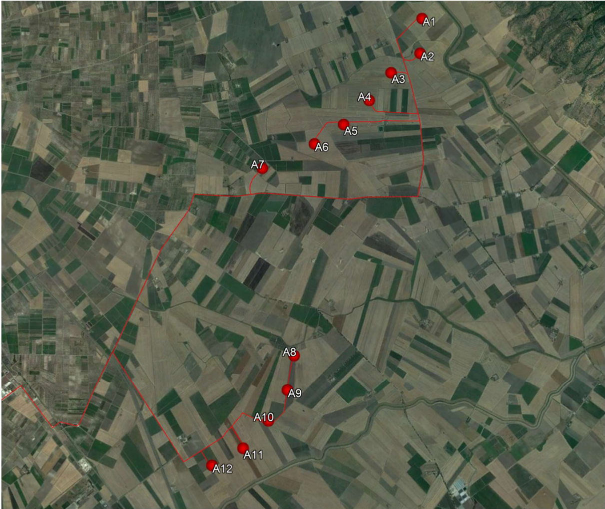
Fig. 2 – Inquadramento su ortofoto degli aerogeneratori: è raffigurato il Campo di Nord costituito da 7 aerogeneratori e il Campo di Sud costituito da 5 aerogeneratori
