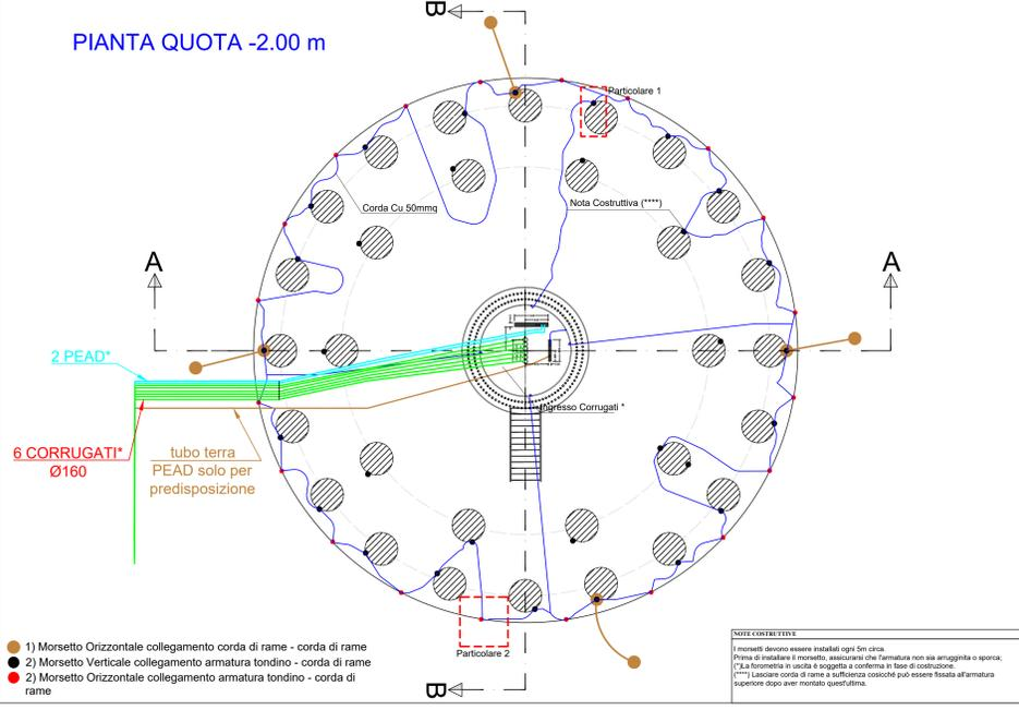
Particolari Posa impianto terra aerogeneratore - Pianta Quota -1.00m (Scala 1:100)
