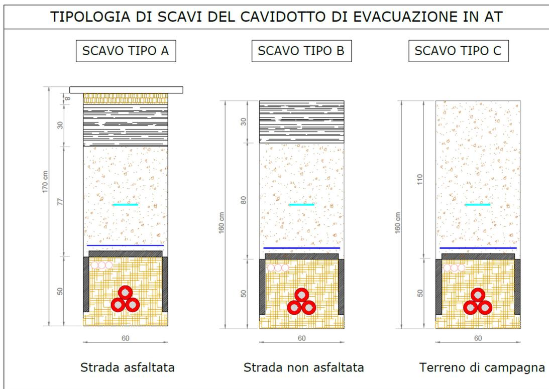
**Figura 37** – Sezioni tipiche di scavo e di posa per il cavo in AT kV
