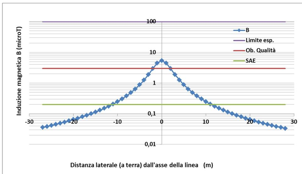
**Figura 30** – Andamento del campo B generato dal cavidotto di evacuazione ad una profondità di circa 2,2 m
