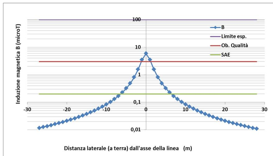
**Figura 20** – Campo di induzione magnetica B ( $\mu\text{T}$ ) generato dal cavidotto in MT interno all'area d'impianto, in relazione ai limiti di esposizione e obiettivo di qualità – n.2 cavi da 240 e 185 mmq
