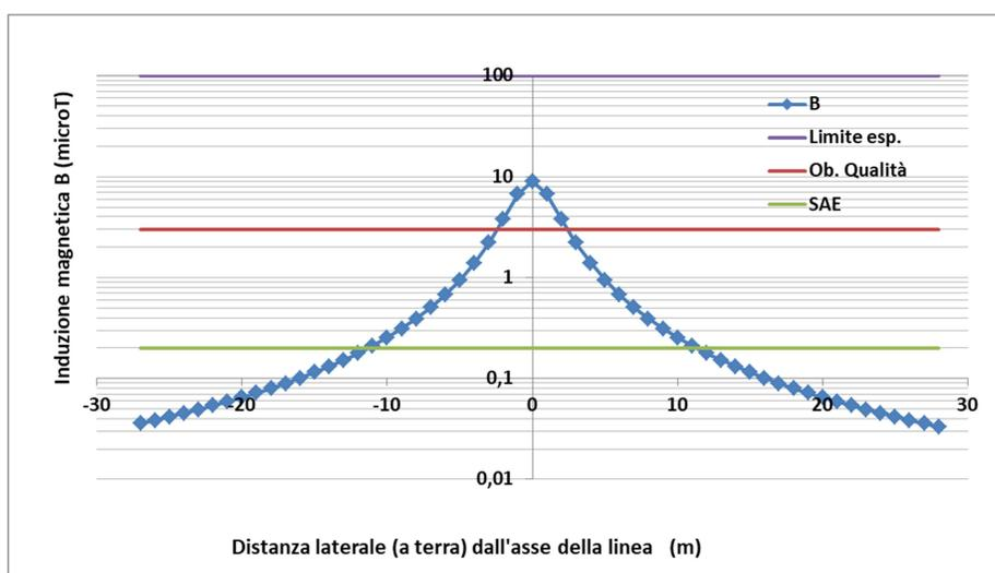
**Figura 29** - Andamento del campo B generato dal cavidotto di evacuazione ad una profondità di circa 1,7 m
