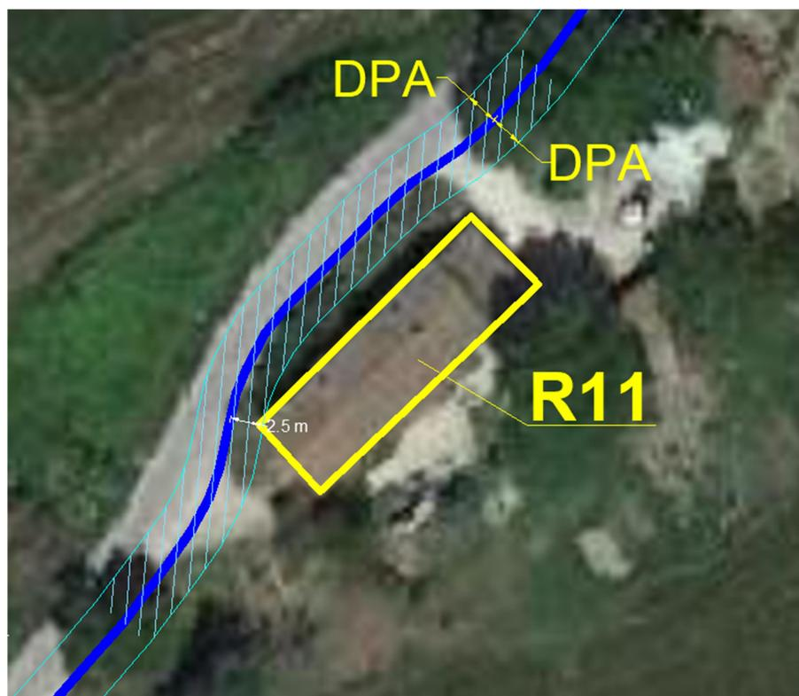
**Figura 27** – Fasce di rispetto del cavidotto di evacuazione nei pressi del ricettore R11
