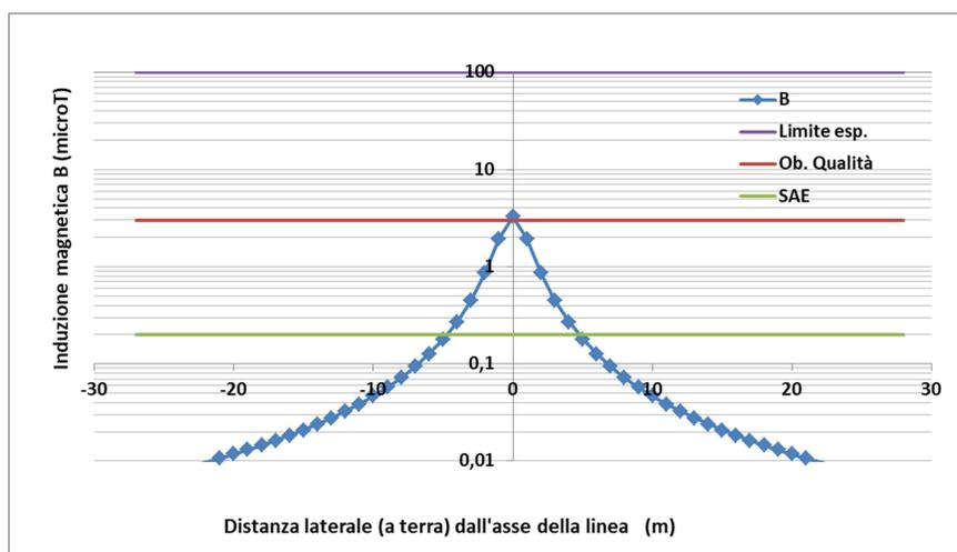
**Figura 17** – Campo di induzione magnetica B ( $\mu\text{T}$ ) generato dal cavidotto in MT interno all'area d'impianto, in relazione ai limiti di esposizione e obiettivo di qualità – n.1 cavi da 240 mmq
