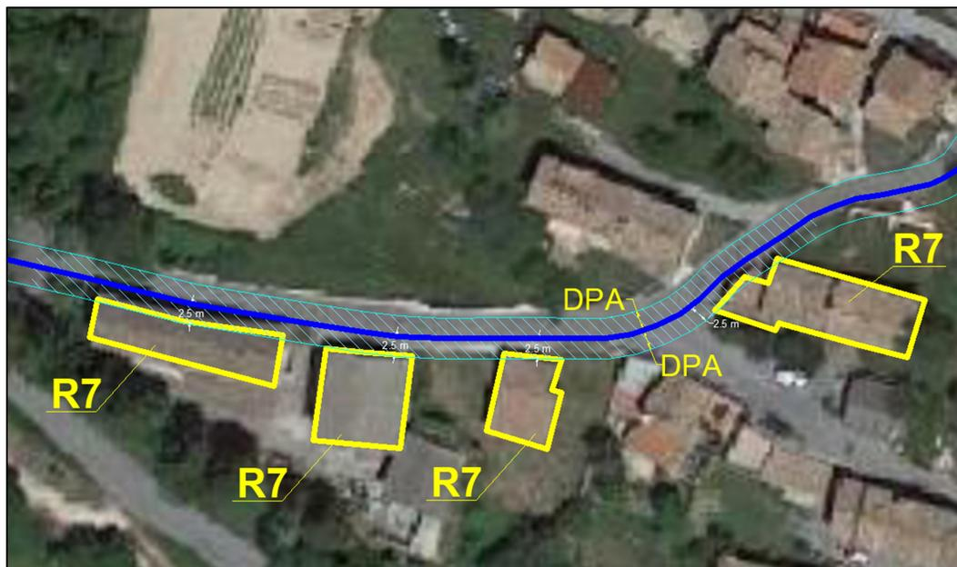
**Figura 23** – Fasce di rispetto del cavidotto di evacuazione nei pressi dei ricettori R7
