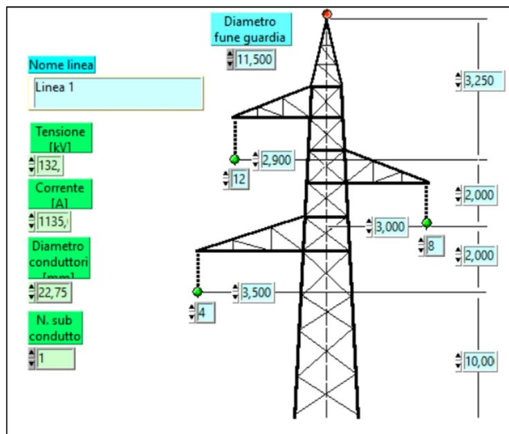
**Figura 41** – Configurazione dei tralicci e linee aeree
