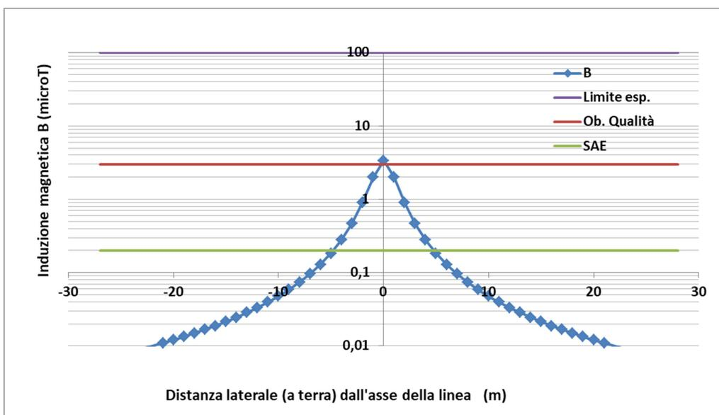
**Figura 18** – Campo di induzione magnetica B ( $\mu\text{T}$ ) generato dal cavidotto in MT interno all'area d'impianto, in relazione ai limiti di esposizione e obiettivo di qualità – n.2 cavi da 95 mmq
