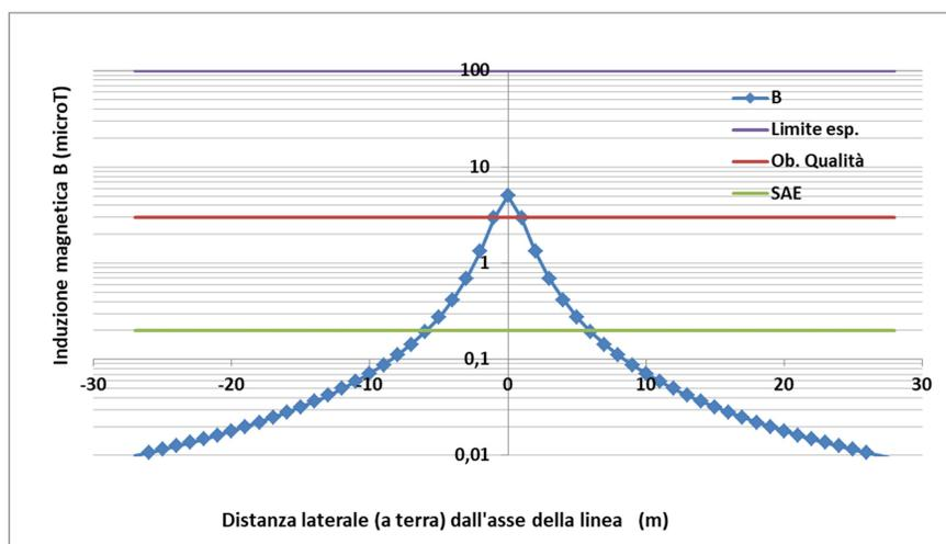
**Figura 16** – Campo di induzione magnetica B ( $\mu\text{T}$ ) generato dal cavidotto in MT interno all'area d'impianto, in relazione ai limiti di esposizione e obiettivo di qualità – n.1 cavi da 400 mmq
