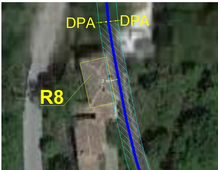
**Figura 24** – Fasce di rispetto del cavidotto di evacuazione nei pressi del ricettore R8
