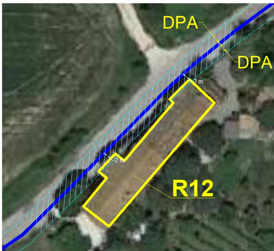
**Figura 28** – Fasce di rispetto del cavidotto di evacuazione nei pressi del ricevitore R12
