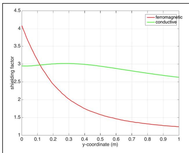
**Figura 31** – Andamento del fattore di schermatura con la distanza dal cavidotto
