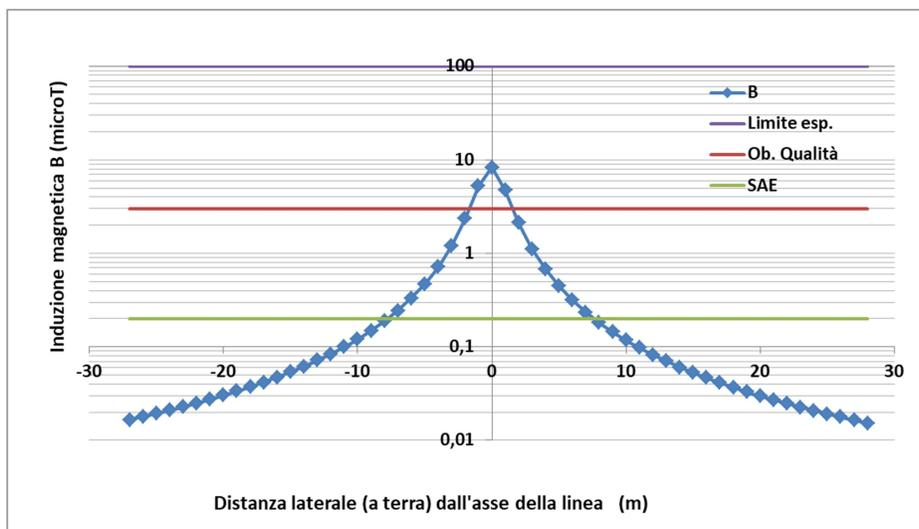
**Figura 14** – Campo di induzione magnetica B ( $\mu\text{T}$ ) generato dal cavidotto in MT interno all'area d'impianto, in relazione ai limiti di esposizione e obiettivo di qualità – n.2 cavi da 95 e n.1 cavi da 400 mmq
