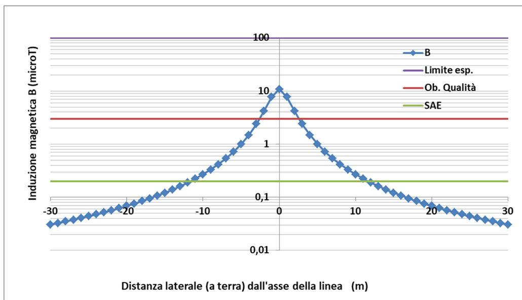
**Figura 38** – Campo di induzione magnetica B ( $\mu T$ ) generato dal cavidotto in AT in relazione ai limiti di esposizione e obiettivo di qualità
