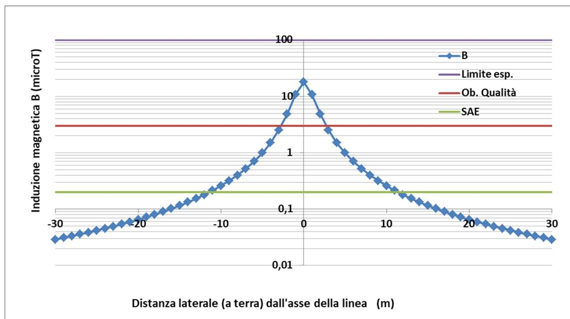
**Figura 21:** Campo di induzione magnetica B ( $\mu T$ ) generato dal cavidotto di evacuazione MT del progetto eolico in relazione ai limiti di esposizione e obiettivo di qualità
