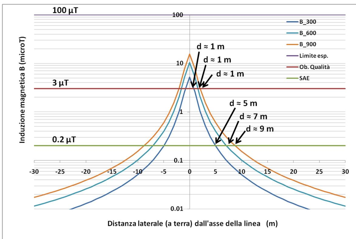
**Figura 5** – Andamento del campo B generato da una terna piana trifase percorsa da corrente di 300 A (blu), 600 A (ciano) e 900 A (arancio) e indicazione delle distanze dalla linea necessarie per rientrare nei limiti di legge e nella SAE.
