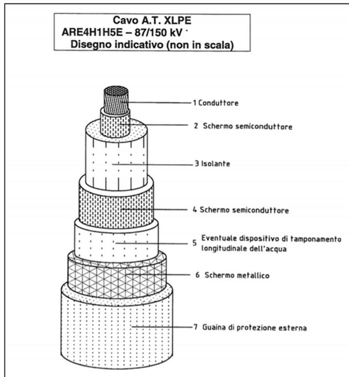
**Figura 35** –Caratteristiche tecniche del cavo in AT a 132 kV
