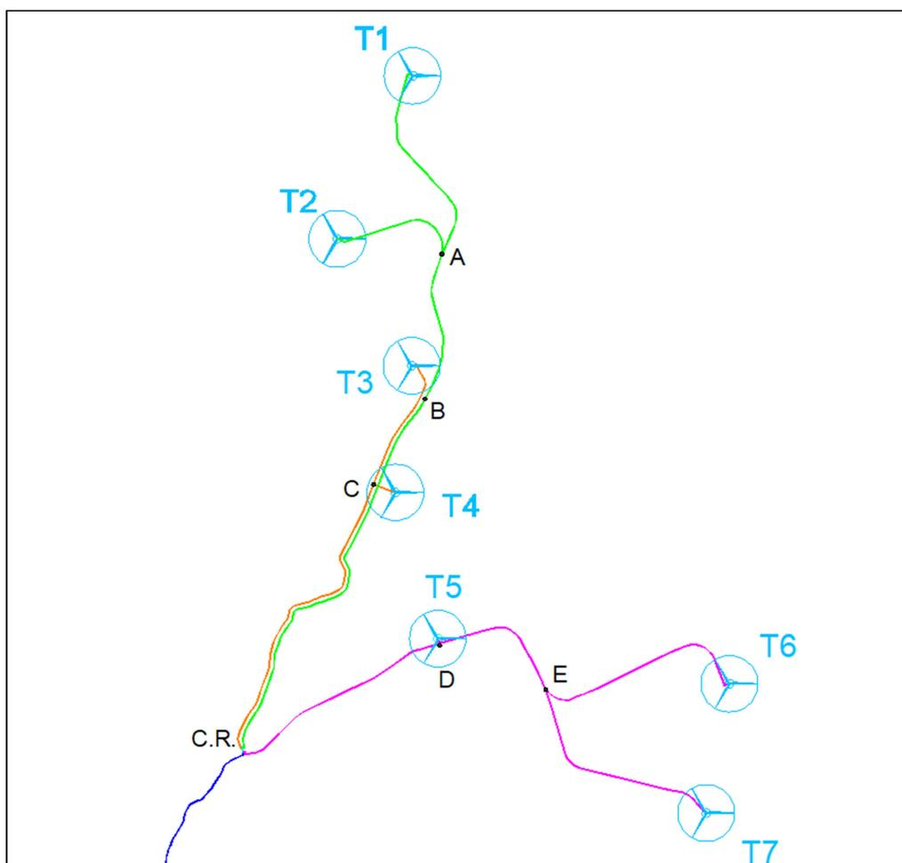
**Figura 8** – Percorsi dei cavidotti tra i gruppi del parco con la cabina di raccolta.
