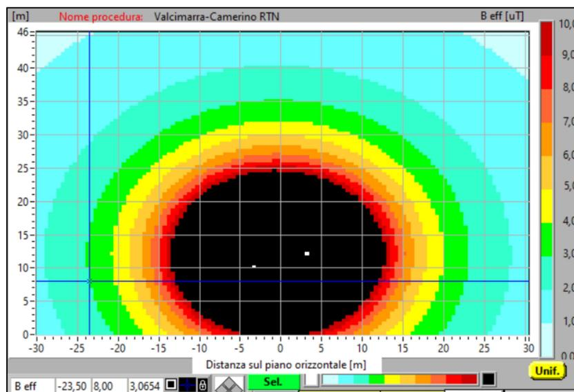
**Figura 40** – Campo di induzione magnetica  $B$  ( $\mu\text{T}$ ) generato dalle linee aeree ad altezza conduttori –  $I=1135\text{ A}$
