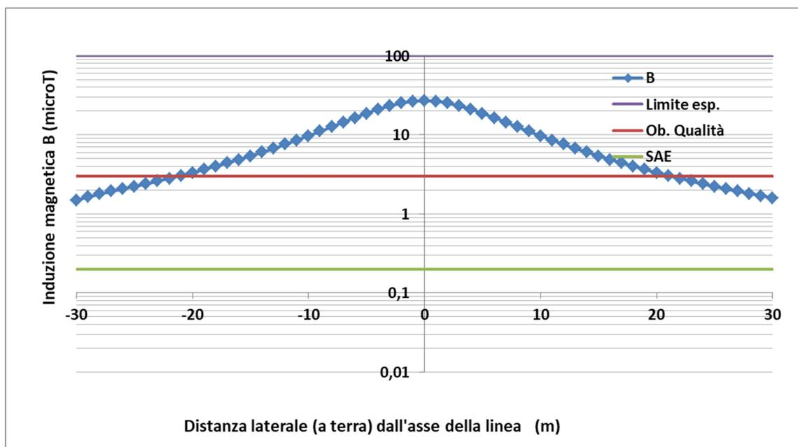
**Figura 33** – Campo di induzione magnetica B ( $\mu T$ ) generato dalle sbarre AT in relazione ai limiti di esposizione e obiettivo di qualità.
