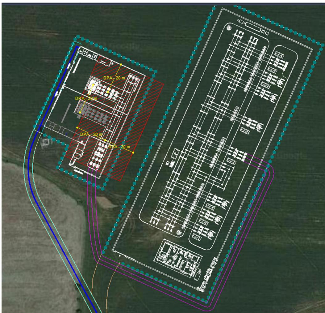
**Figura 34** – Inquadramento su mappa ortofoto della stazione utente di trasformazione MT/AT 30/132 kV – in rosso la fascia di rispetto con  $B > 3 \mu T$
