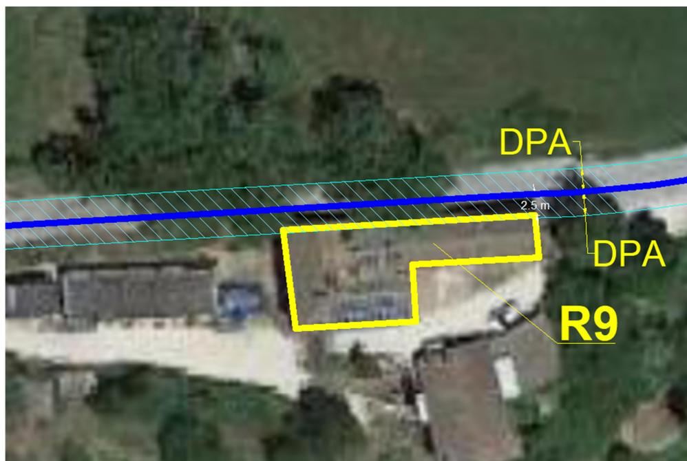
**Figura 25** – Fasce di rispetto del cavidotto di evacuazione nei pressi del ricettore R9
