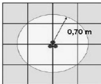
Si evince che il cavo da 185 mmq, con un valore di portata di 325 A, interrato ad 1 m di profondità, genera un campo B pari a 3  $\mu\text{T}$  ad una distanza di circa 0,7 m. Mentre, con lo stesso metodo analitico, un cavo da 240 mmq, con una portata di 441 A, anch'esso interrato ad 1 m di profondità, ha una DPA di circa 0,9 m dal centro del cavo stesso.
