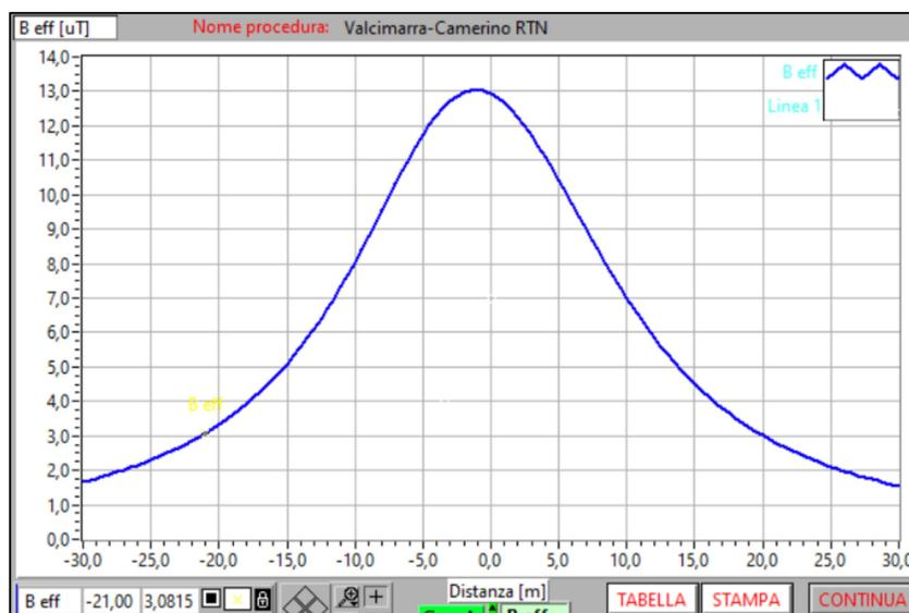
**Figura 39** – Campo di induzione magnetica  $B$  ( $\mu T$ ) generato dalle linee aeree ad 1 m dal suolo –  $I=1135 A$
