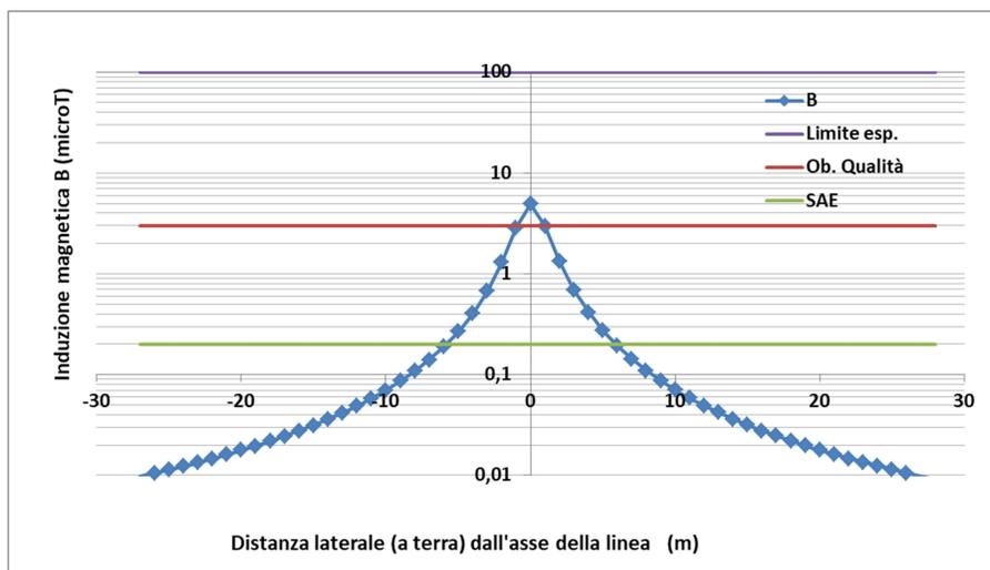
**Figura 15** – Campo di induzione magnetica B ( $\mu\text{T}$ ) generato dal cavidotto in MT interno all'area d'impianto, in relazione ai limiti di esposizione e obiettivo di qualità – n.1 cavi da 240 e n.1 da 95 mmq
