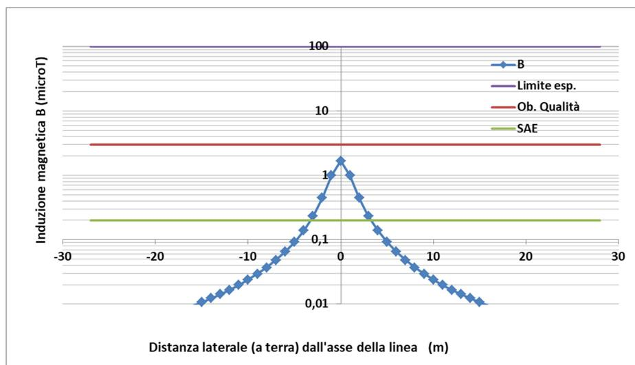
**Figura 13** – Campo di induzione magnetica B ( $\mu\text{T}$ ) generato dal cavidotto in MT interno all'area d'impianto, in relazione ai limiti di esposizione e obiettivo di qualità – sez. n.1 cavo da 95 mmq
