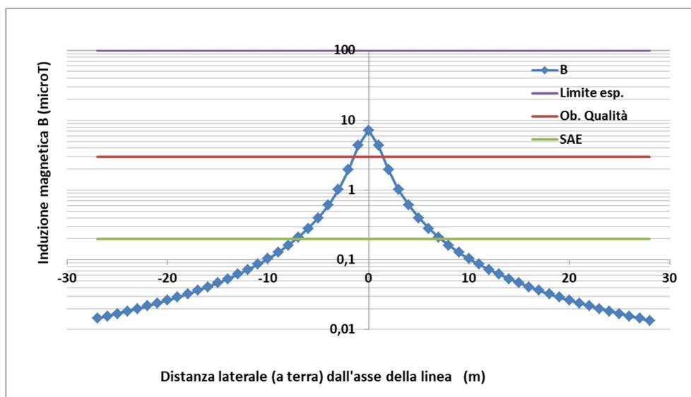
**Figura 32** – Campo di induzione magnetica B ( $\mu\text{T}$ ) generato dal cavidotto di evacuazione MT con i valori della corrente massima prodotta dalle turbine in relazione ai limiti di esposizione e obiettivo di qualità
