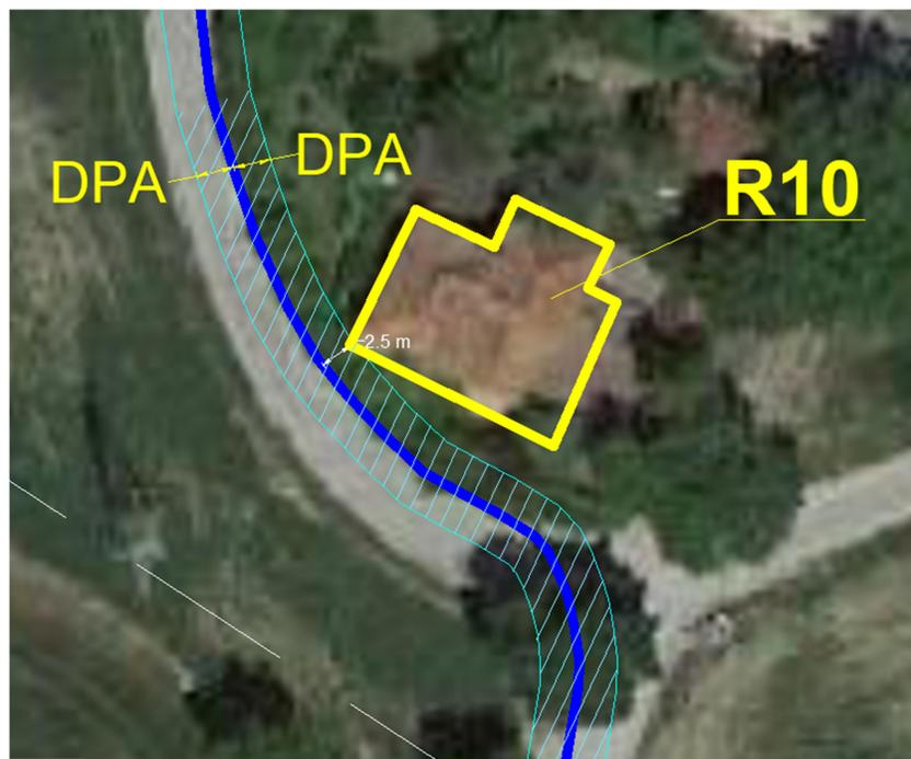
**Figura 26** – Fasce di rispetto del cavidotto di evacuazione nei pressi del ricettore R10
