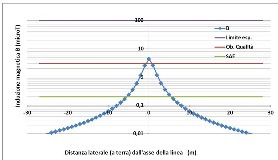
**Figura 19** – Campo di induzione magnetica  $B$  ( $\mu T$ ) generato dal cavidotto in MT interno all' area d'impianto, in relazione ai limiti di esposizione e obiettivo di qualità – n.2 cavi da 95 e 185 mmq
