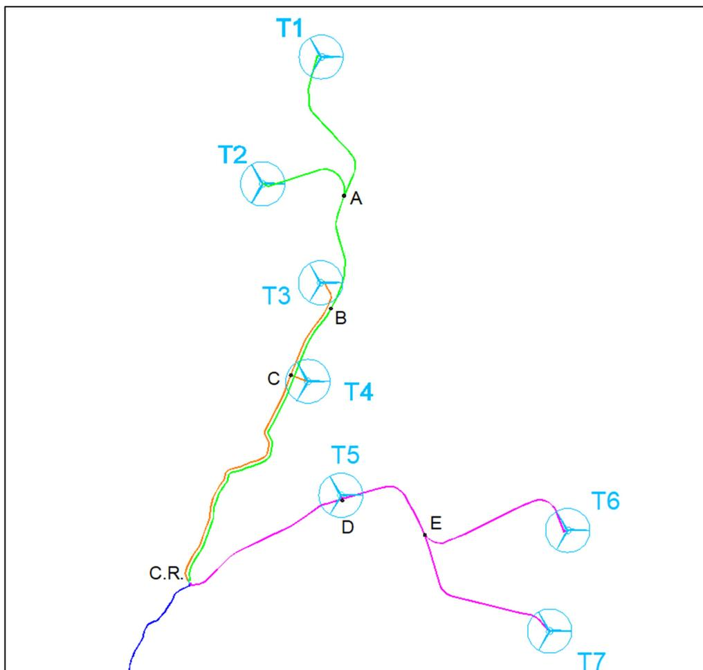
Figura 2 - Percorsi dei cavidotti tra i gruppi del parco con la cabina di raccolta.
