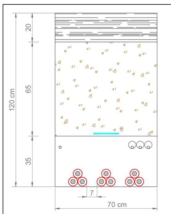
*Figura 8 – Sezione tipo del cavidotto interrato MT composto da n.3 terne di cavi su strada sterrata*
