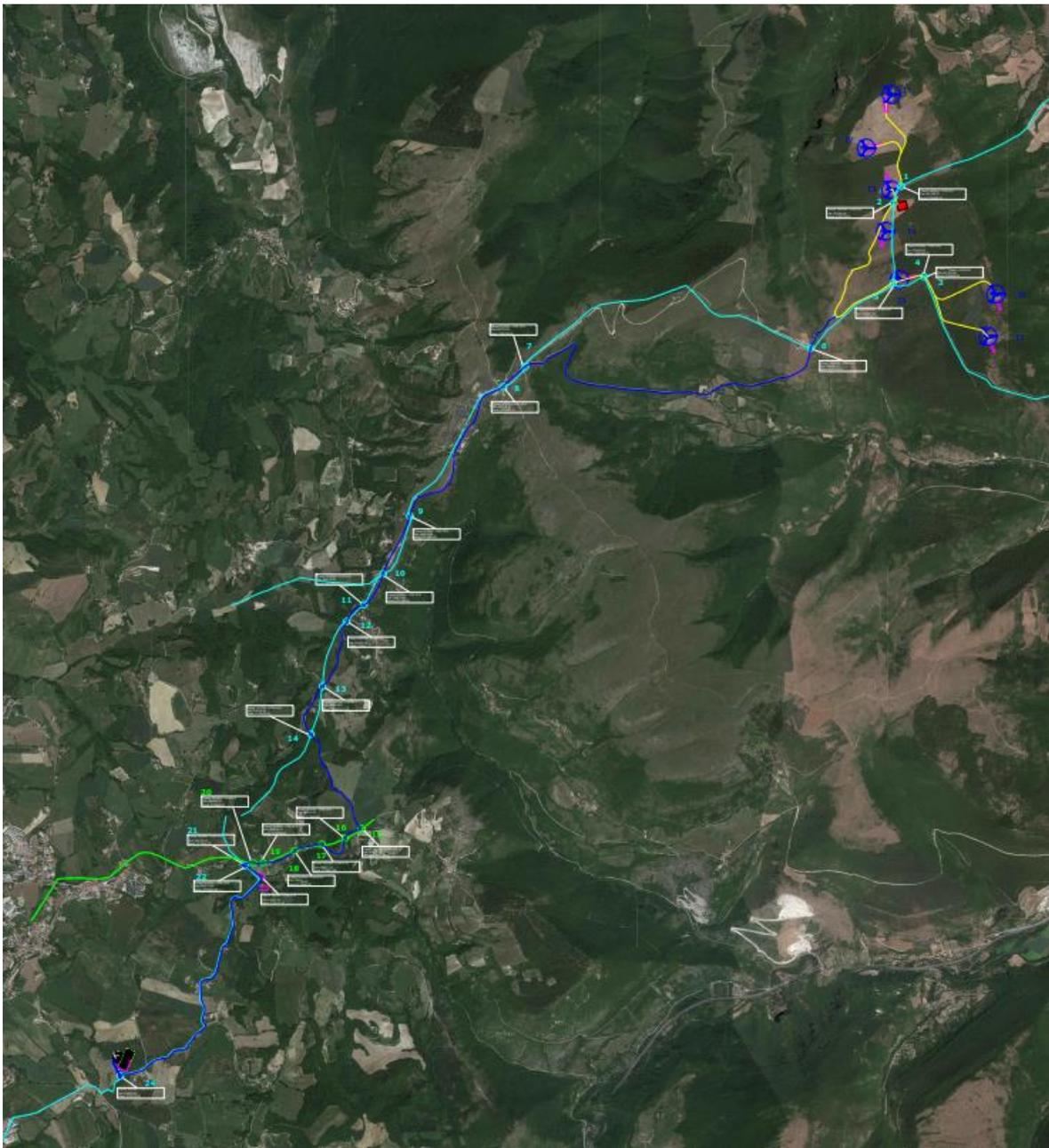
*Figura 11: Inquadramento su ortofoto: impianto eolico, cavidotti in MT (in giallo e in blu) e attraversamento delle interferenze*
