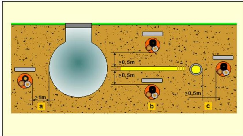
Figura 6: Distanze minime con altri cavi, tubazioni metalliche, serbatoi e cisterne di carburante.
