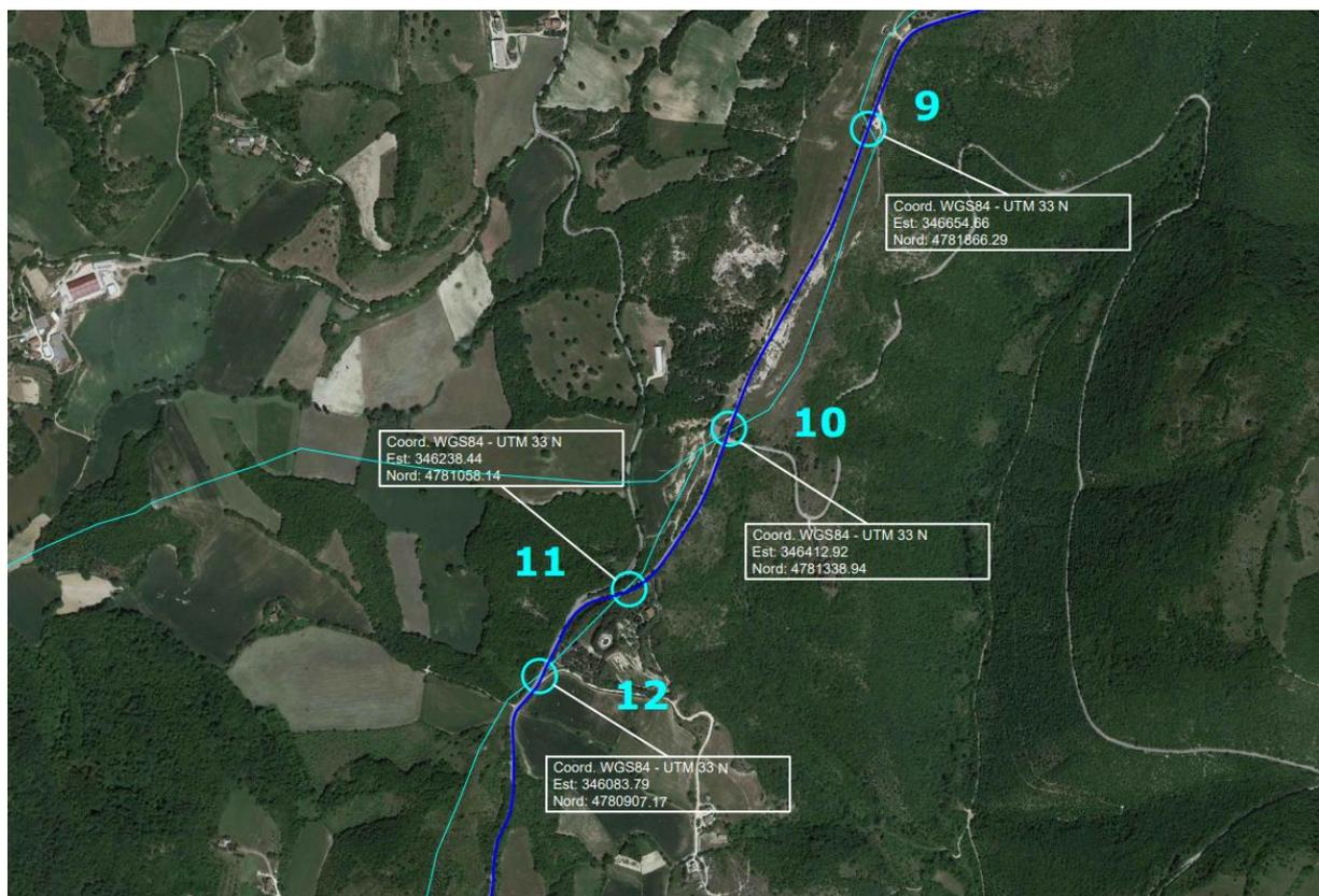
Figura 15: dettaglio 4 in cui è visibile l'attraversamento dei metanodotti interrati (ciano) in quattro punti (N° 9-12)
