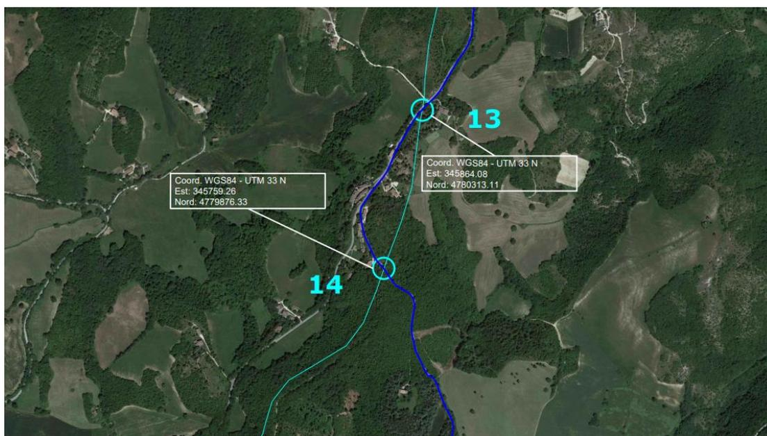
Figura 16: dettaglio 5 in cui è visibile l'attraversamento dei metanodotti interrati (ciano) in due punti (N°13,14)
