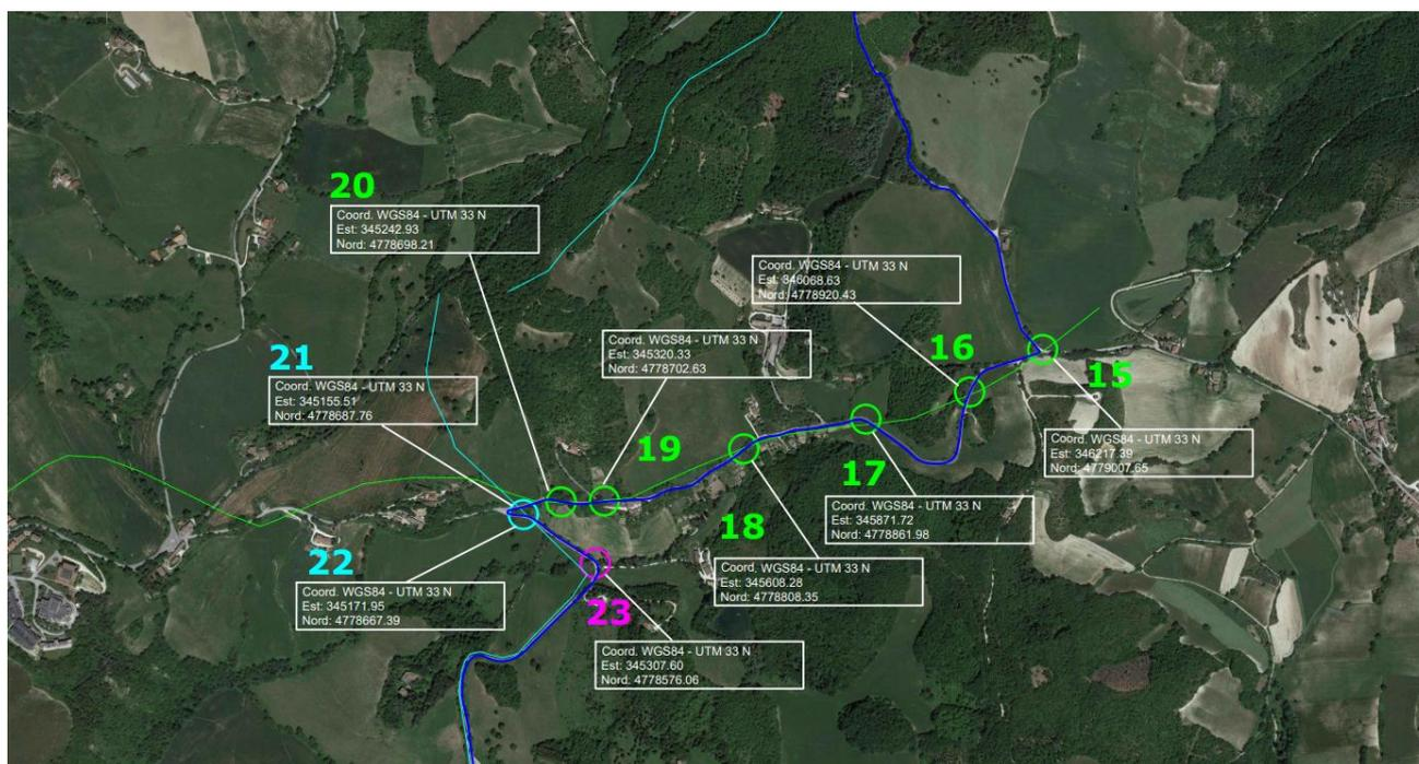
Figura 17: dettaglio 6 in cui è visibile l'attraversamento un acquedotto interrato (verde) in 6 punti (N° 15-20), l'attraversamento de un metanodotto interrato in 2 punti (N°21-22) e l'attraversamento di un corso d'acqua (magenta) in un punto (N°23). Tratti di parallelismo fra cavidotto di evacuazione e il metanodotto
