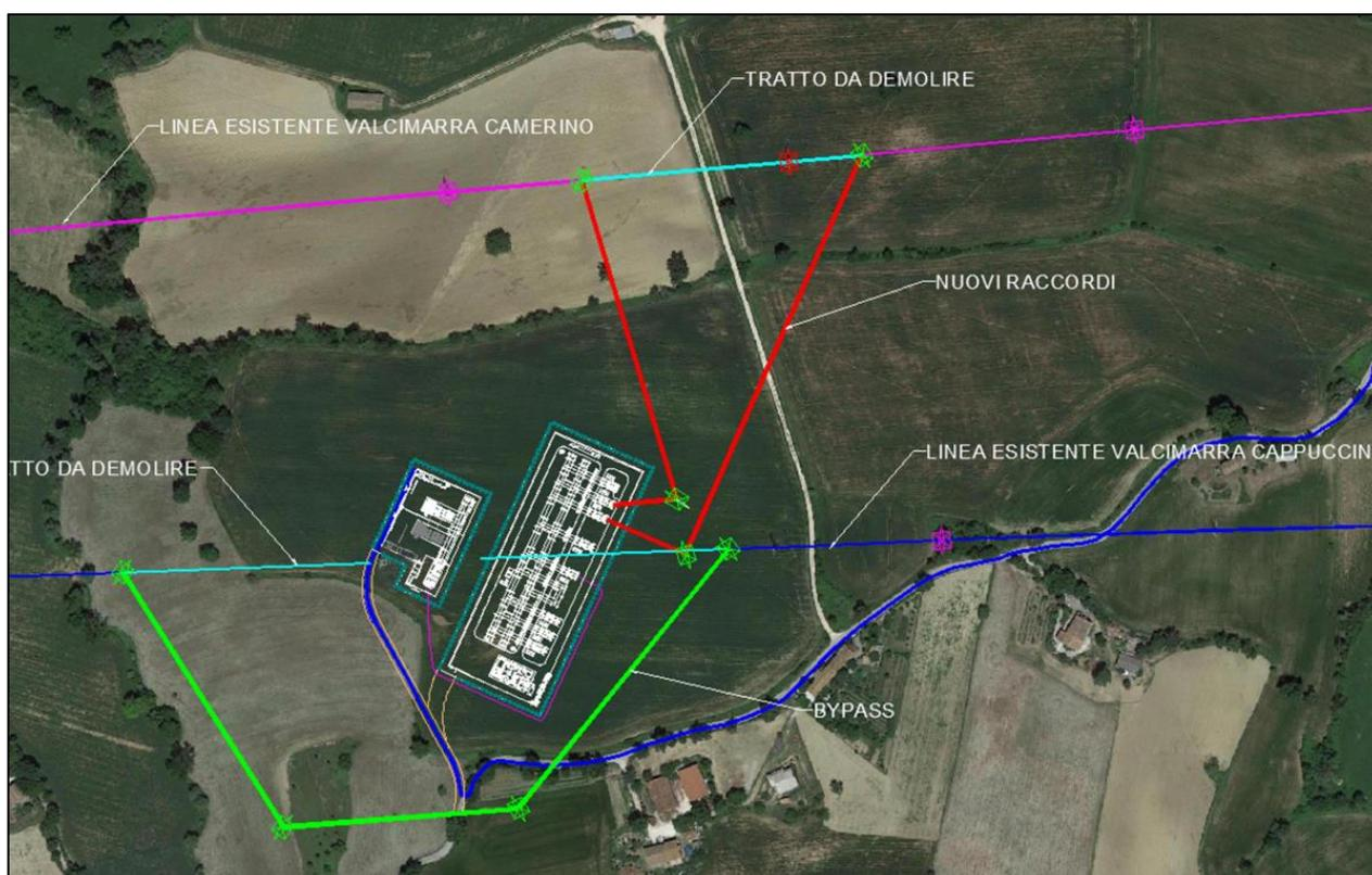
*Figura 19: Inquadramento su ortofoto: stazione utente collegata con la stazione elettrica di smistamento a 132 kV da realizzare in località di "Arcofiato", il cavidotto in AT di collegamento condiviso (magenta)*
