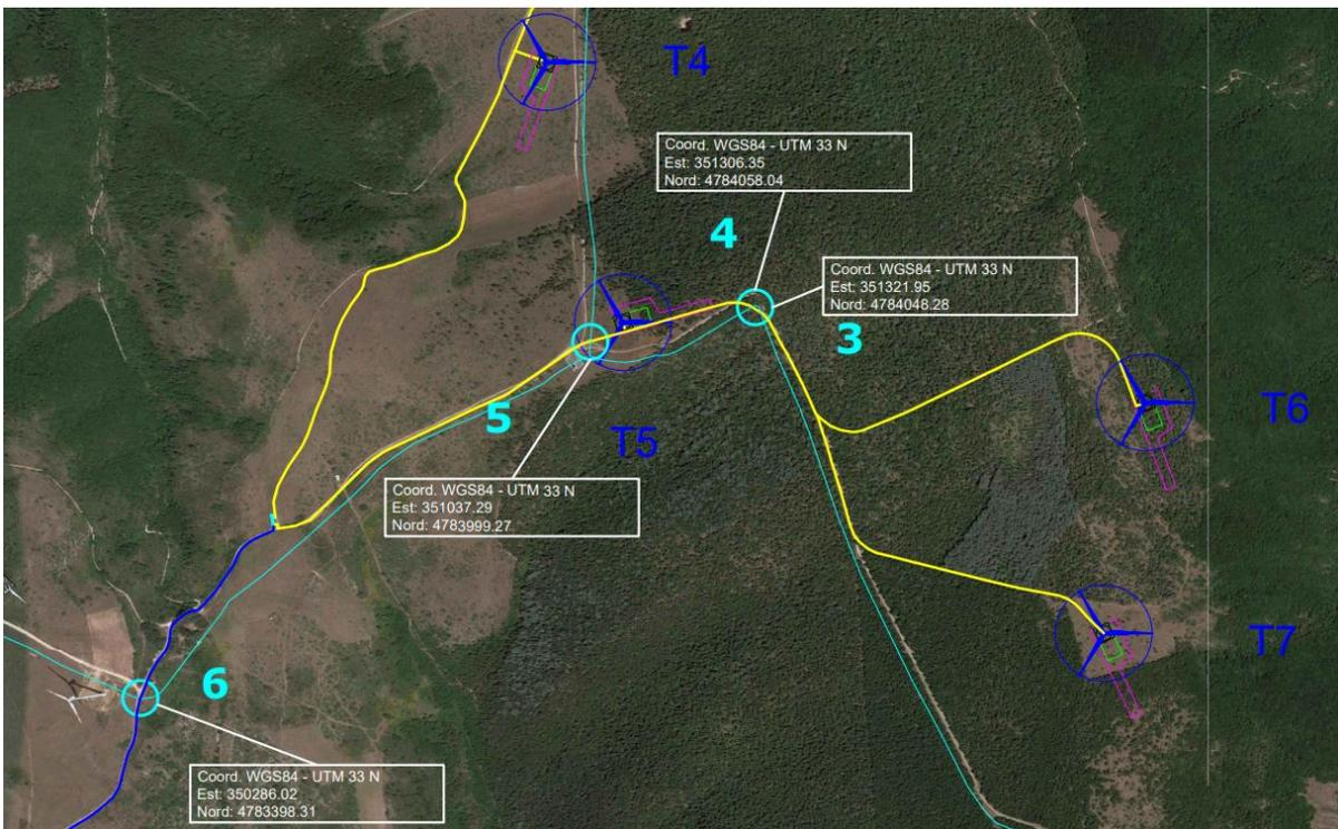
Figura 13: dettaglio 2 in cui è visibile l'attraversamento dei metanodotti interrati (ciano) in 4 punti (N°3-6)
