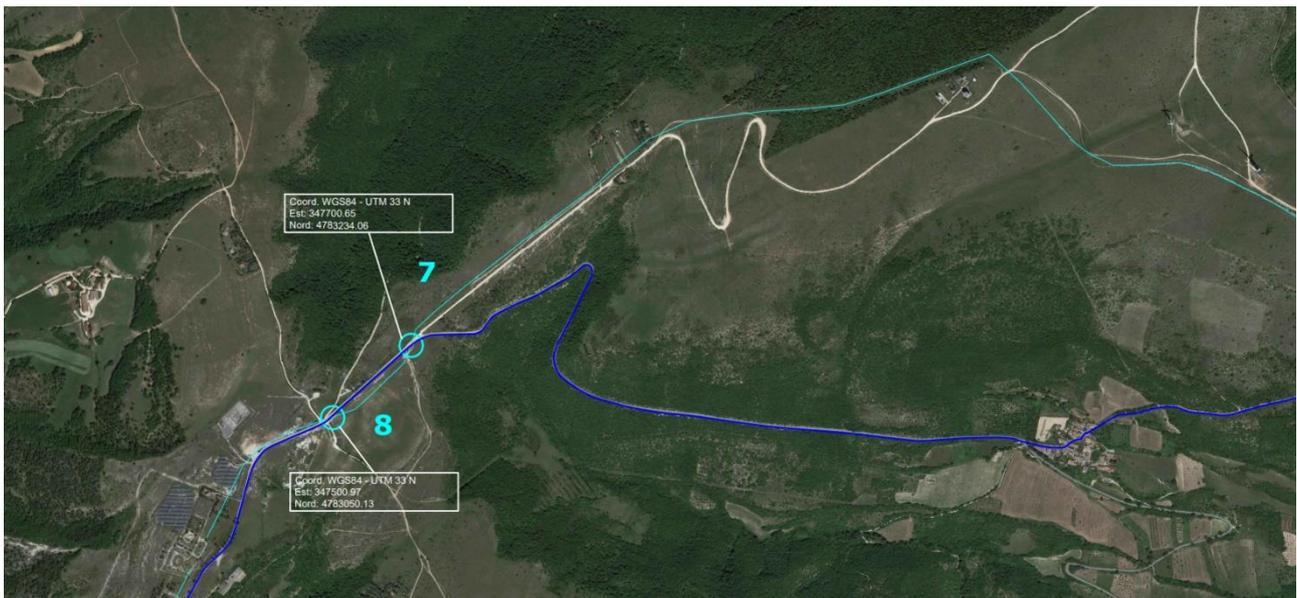
Figura 14: dettaglio 3 in cui è visibile l'attraversamento del metanodotto interrato (ciano) in due punti (N°7,8)
