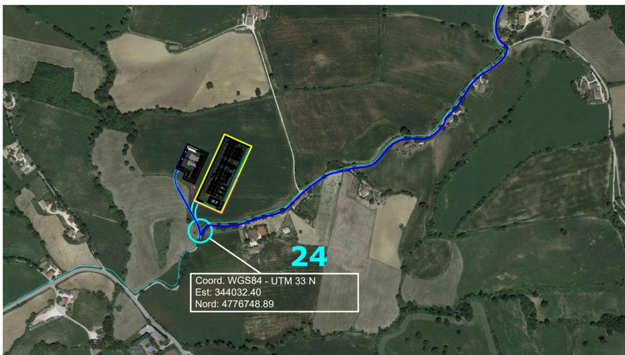
*Figura 18: dettaglio 7 in cui è visibile un tratto di parallelismo fra cavidotto (blu) e metanodotto (ciano), nonché l'attraversamento del metanodotto interrato in punto (N°24), e il cavidotto in AT a 132 kV (in ciano), la stazione utente di trasformazione e la Stazione Elettrica di Smistamento*
