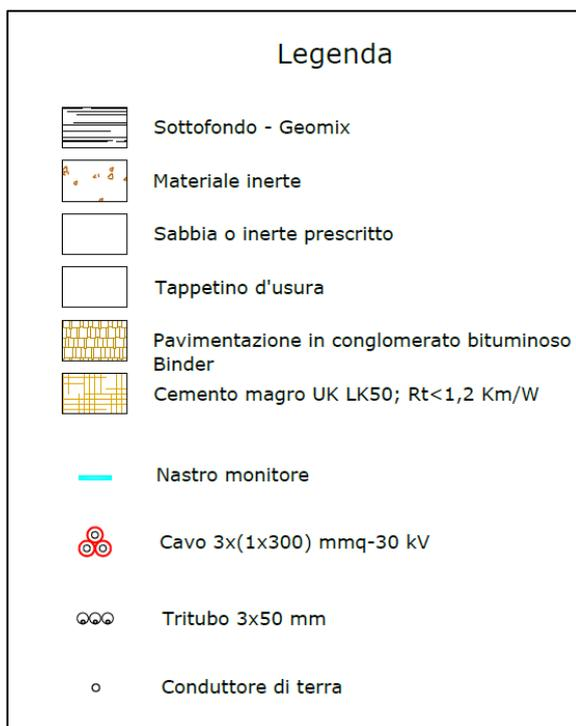
Figura 10: Materiali di riempimento per tipologia di scavo
