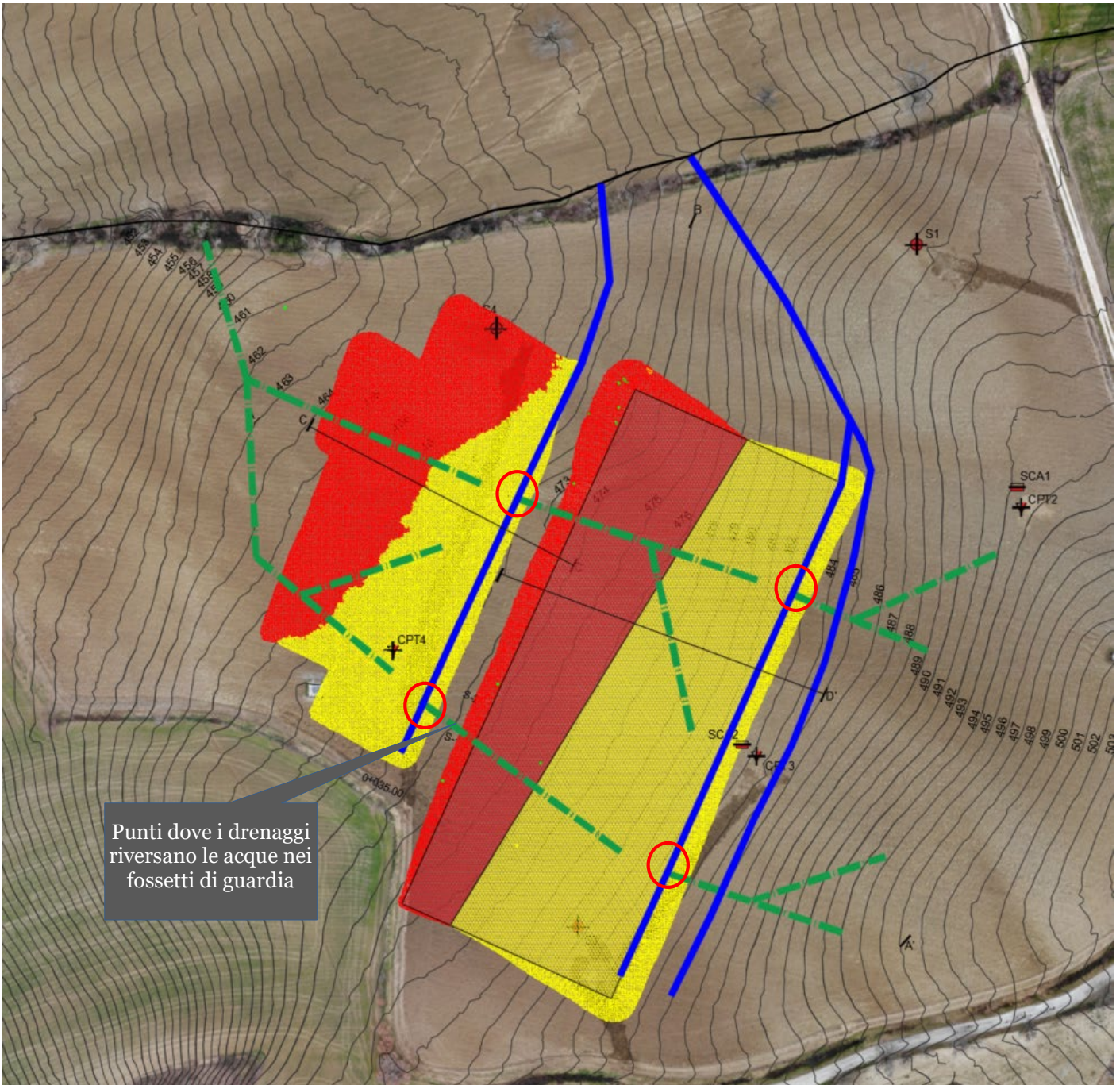
Figura 39 schema posizione drenaggi (le aree delle centrali si riferiscono ad un precedente progetto)
