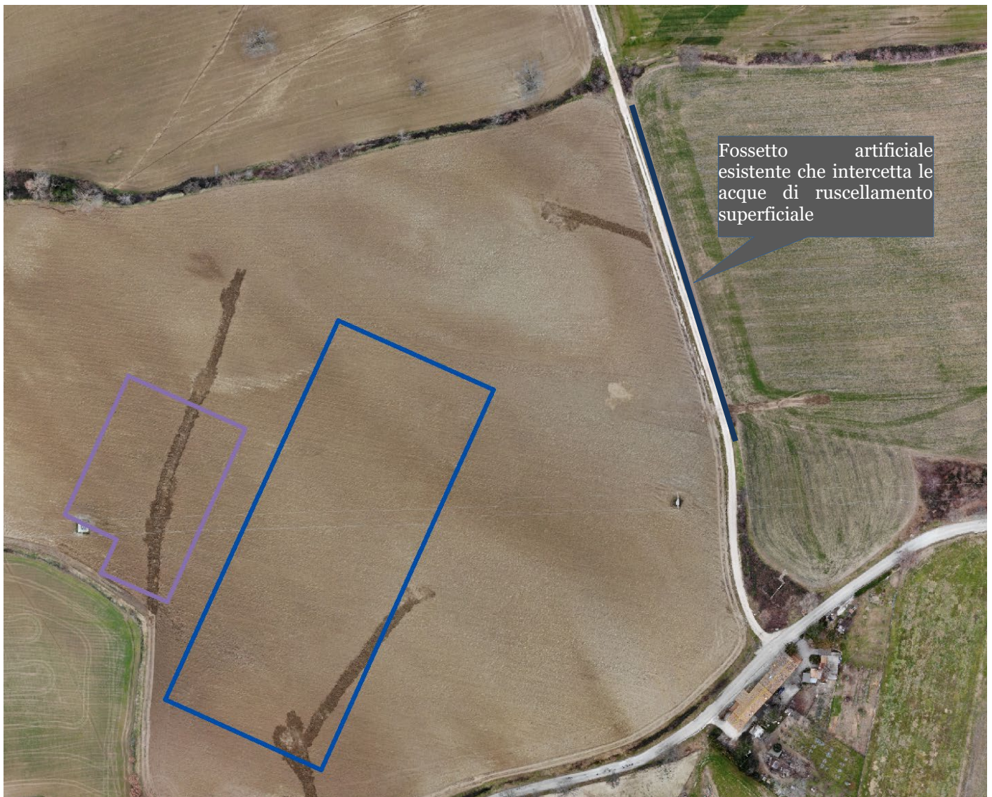
Figura 36 posizione del fosso artificiale bodo strada che raccoglie gran parte delle acque che scende da monte
