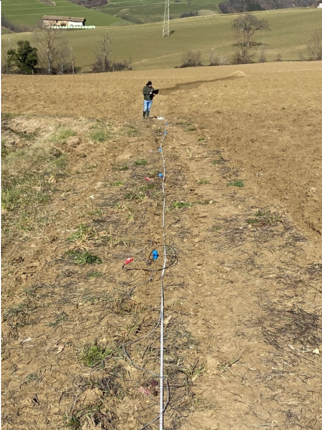
Figura 29 cantiere prova MASW
