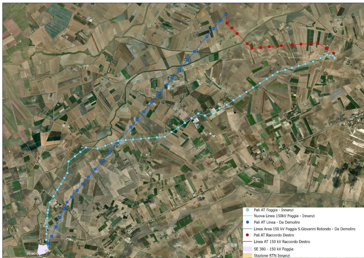
Figura 2.3: Inquadramento Territoriale dell'intervento, in blu: Linea Aerea 150 kV Foggia San Giovanni Rotondo (da demolire), in azzurro: Linea Aerea 150 kV Foggia – Innanzi, in rosso: Linea At 150 kV Raccordo Destro. In rosa: SE 380 – 150 “Foggia”, in giallo: Stazione RTN “Innanzi”.
