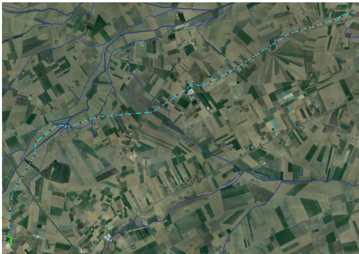
Figura 11: posizionamento dei sostegni rispetto al reticolo idrografico
