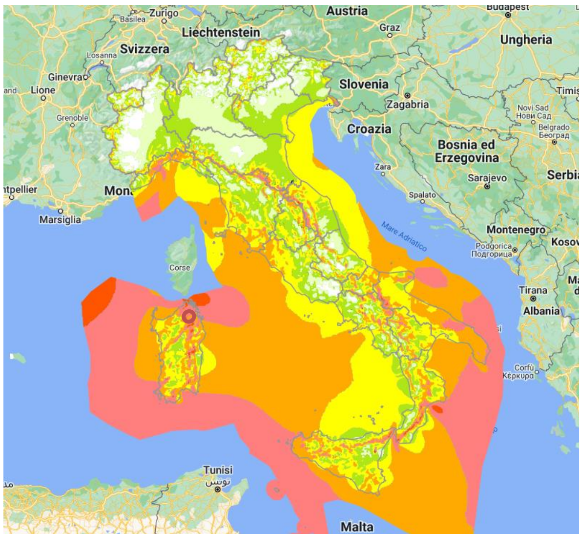
Figura 4 - Atlante Eolico d'Italia –Velocità media annua del vento a 100 m s.l.t./s.l.m. Fonte: RSE-Web
