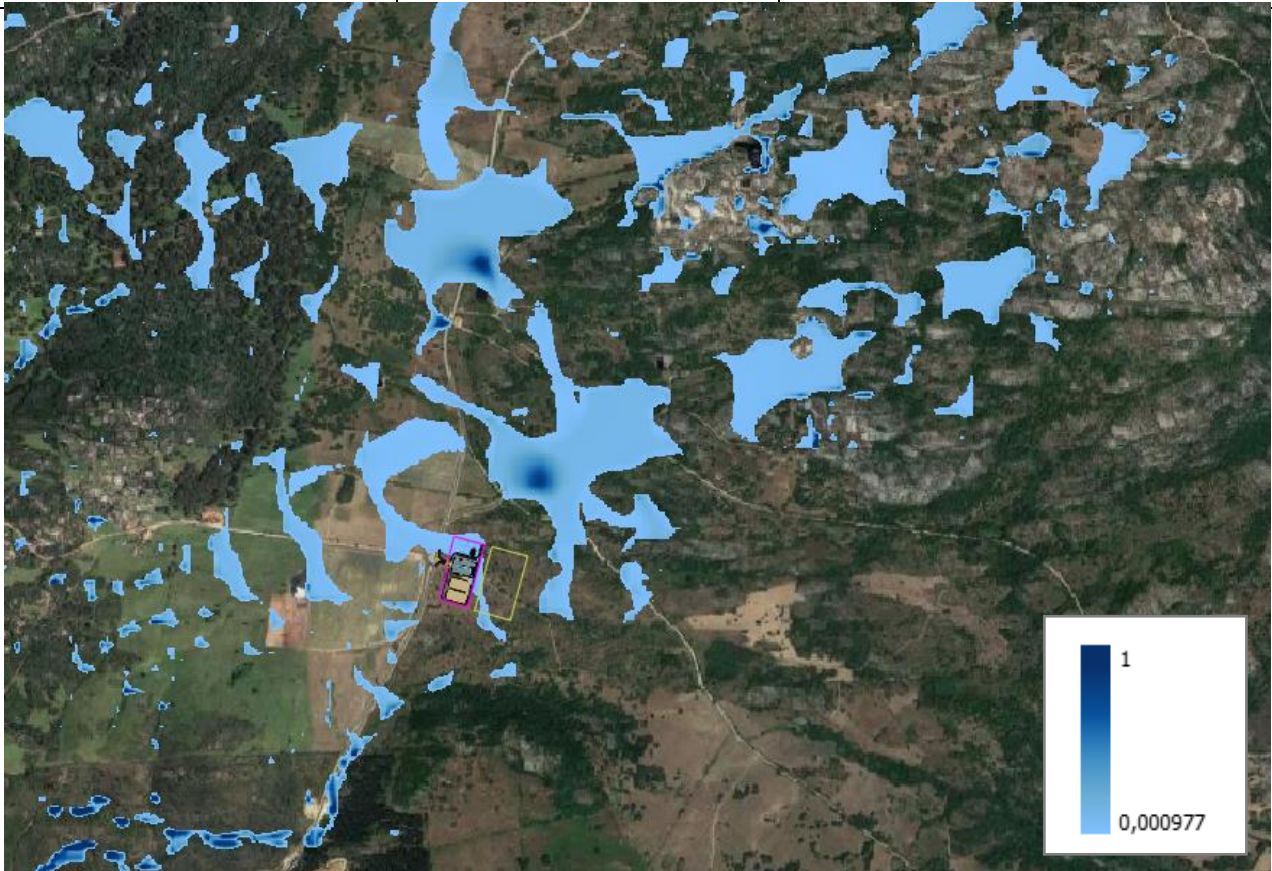
Figura 24 - Tirante idrico (Depth) per effetto della propagazione della portata di picco corrispondente a Tr = 200 anni dell'area SSE
