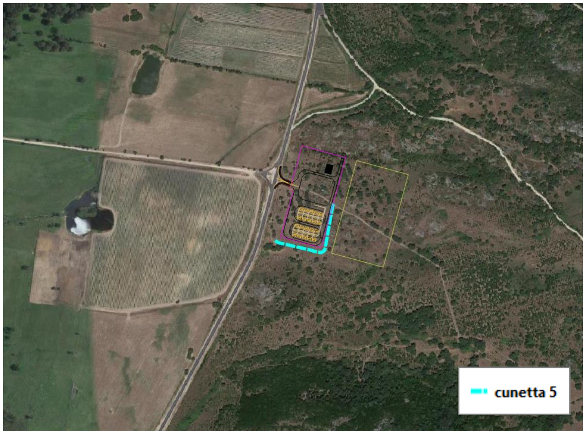
Figura 35: Posizionamento delle cunette dimensionate per la viabilità SSE
