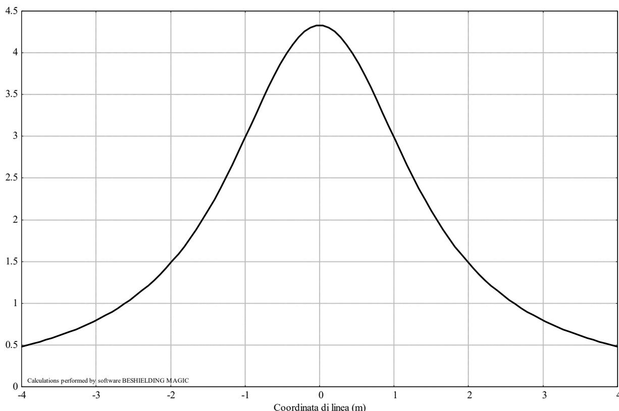
**Figura 4 – Valori di induzione magnetica sul livello stradale del cavidotto MT formato da tre terne di cavi a 30kV.**
