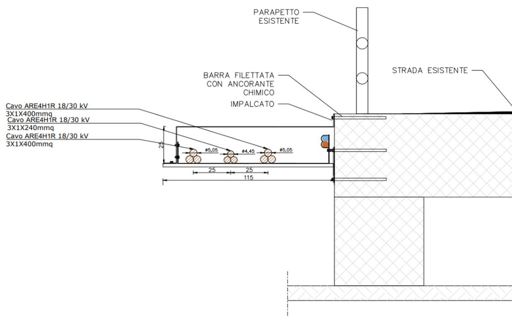
**Figura 5 – Sezione linea MT in fiancheggiamento ponte**
