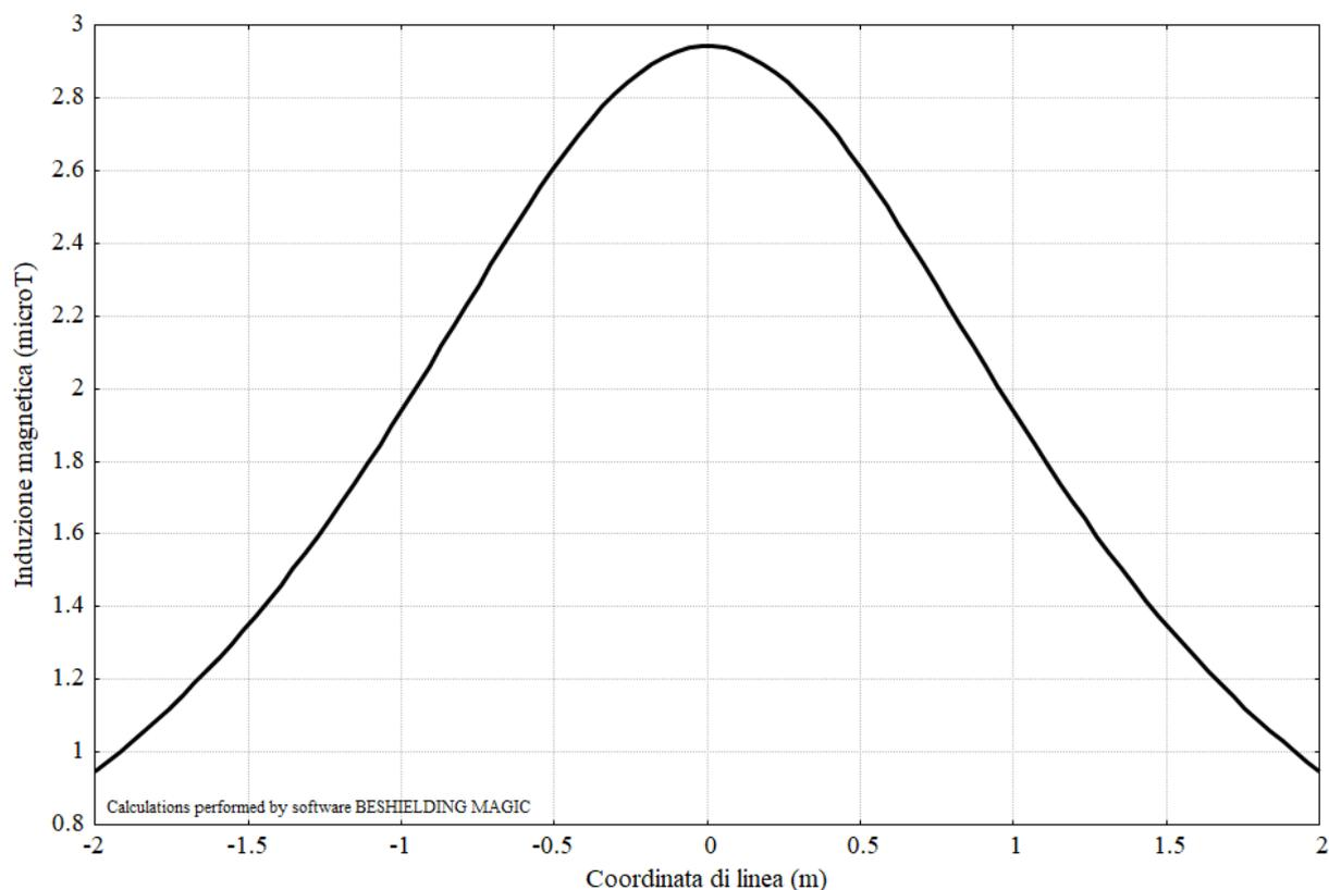
Figura 8 - Valori di induzione magnetica sul livello stradale del cavidotto MT dell'impianto BESS.
