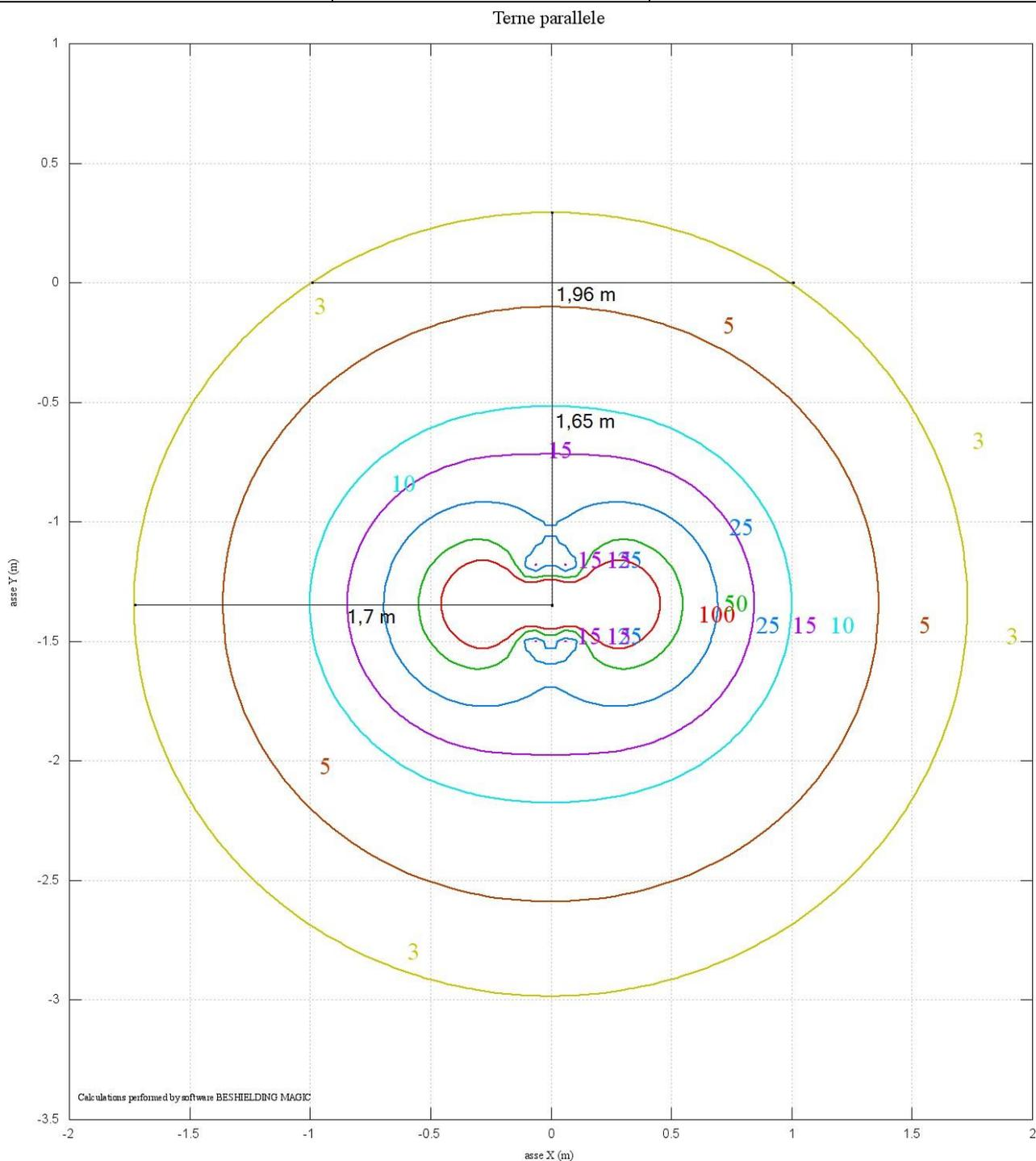
**Figura 3 - Curve di isolivello – simulazione cavidotto MT formato da tre terne di cavi a 30 kV.**
