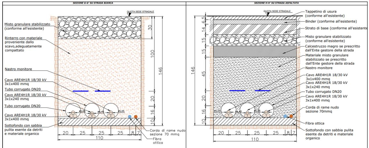
Figura 2 - Sezione cavidotto MT composto da tre terne di cavi a 30 kV su strada asfaltata e su strada bianca.
