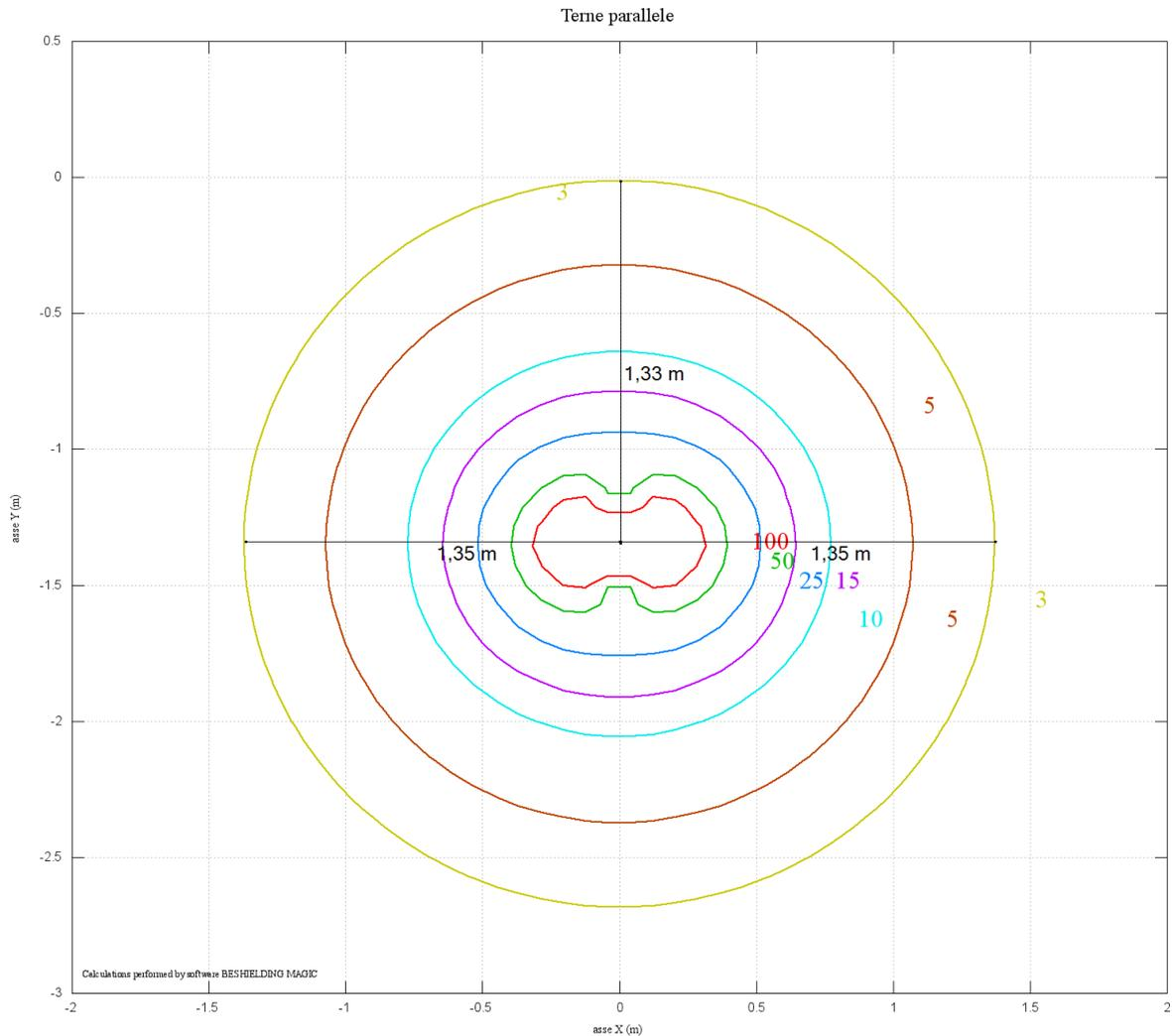
**Figura 7 - Curve di isolivello – simulazione cavidotto MT dell'impianto BESS.**
