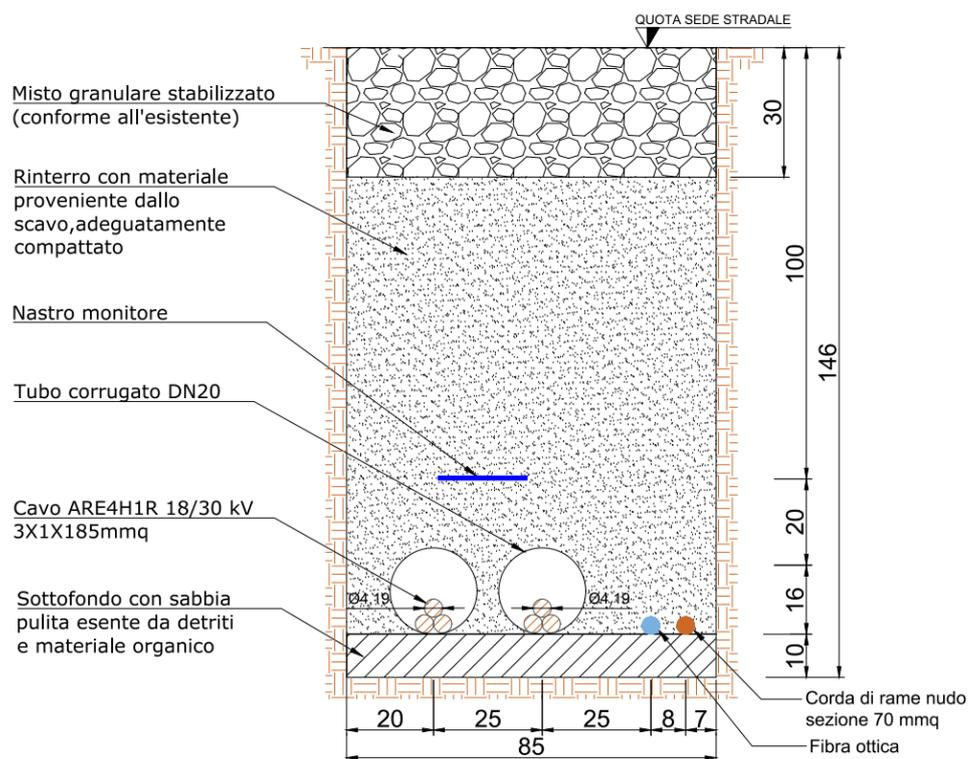
**Figura 6 - Sezione cavidotto MT dell'impianto BESS composto da due terne di cavi a 30 kV su strada bianca.**
