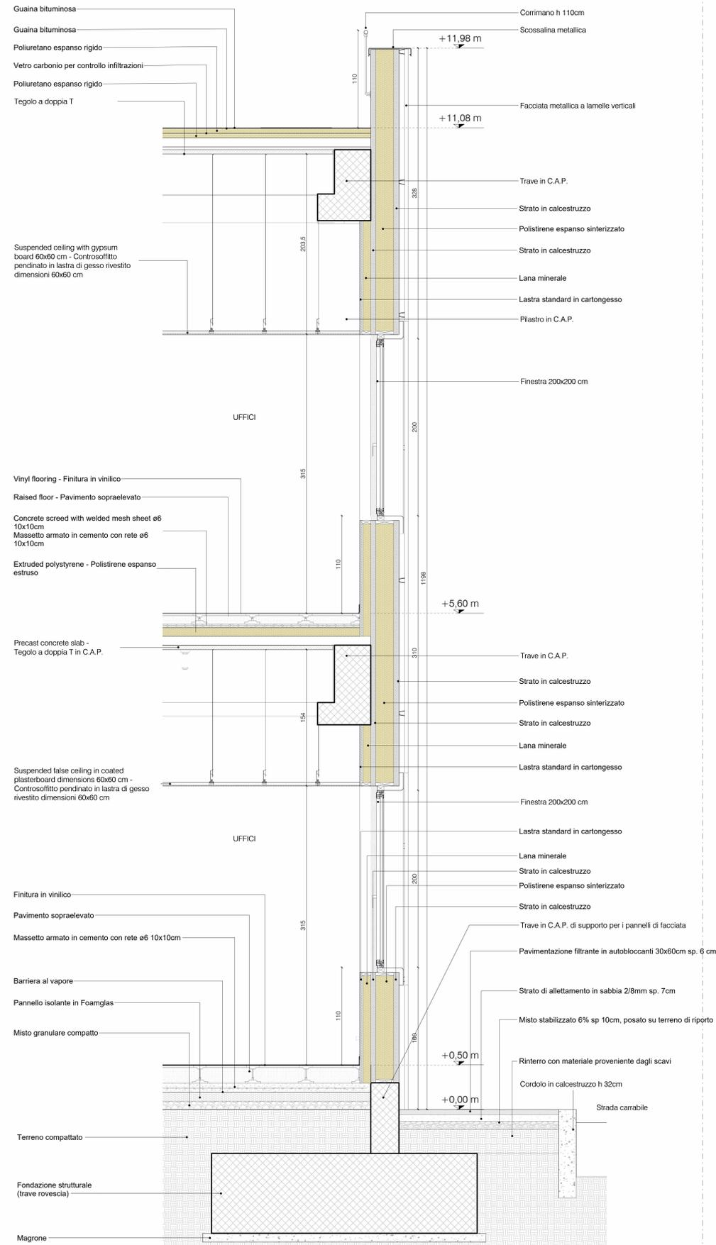
D02\_Sezione verticale di dettaglio zona Sala Dati
