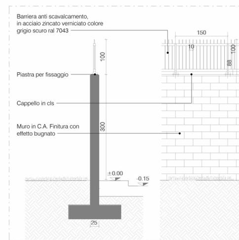
Stato di Progetto - Dettaglio del muro di recinzione
