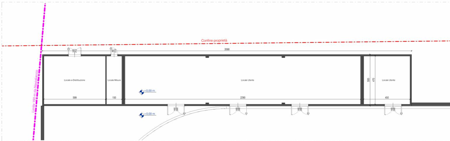
Stato di Progetto - Cabina di media tensione - Pianta Piano Terra
