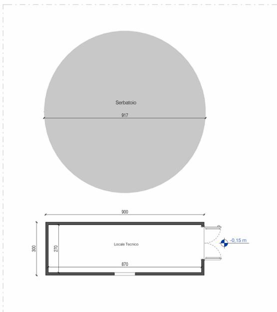
Stato di Progetto - Locale pompe e serbatoio - Pianta Piano Terra
