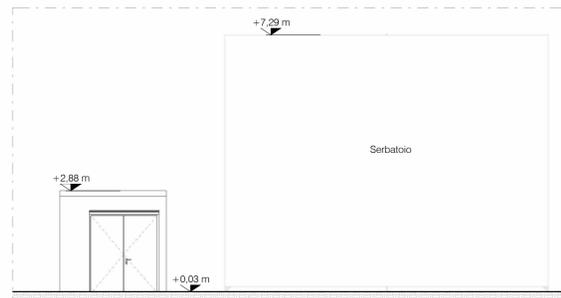
Stato di Progetto - Locale pompe e serbatoio - Prospetto Est
