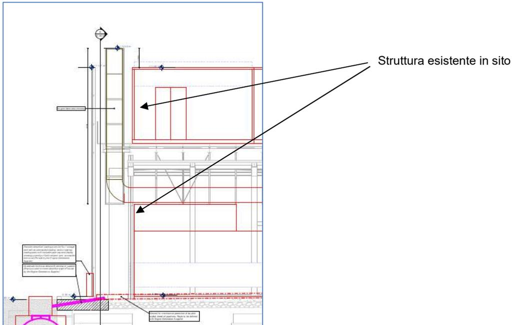
si ipotizza di poter supportare il camino con collari da ancorare alla struttura presente in sito, così come di poter fissare la piastra di sostegno di fondo ad attacco opportunamente predisposto sul basamento in calcestruzzo ospitante il gruppo elettrogeno. I collari di fissaggio della canna fumaria così come la piastra di fondo della stessa saranno dotati di apposite piastre che verranno fissate a punti di ancoraggio da Voi predisposti .
