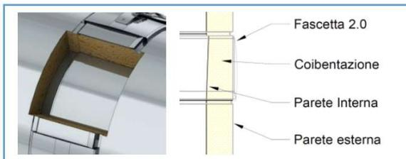
**Sistema di giunzione interno maschio / femmina con profilo conico metallo su metallo costruito in modo tale che collegando i tubi si produca un contatto su tutta la superficie di collegamento (60 mm), la tipologia di giunzione garantisce una tenuta alla pressione H1 (5.000 Pascal) e temperatura (T600) senza l'ausilio di guarnizioni di tenuta silconiche e/o mastici sigillanti**
