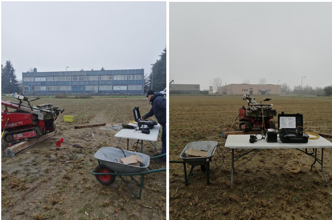
Esecuzione delle indagini sismiche "Down Hole".
