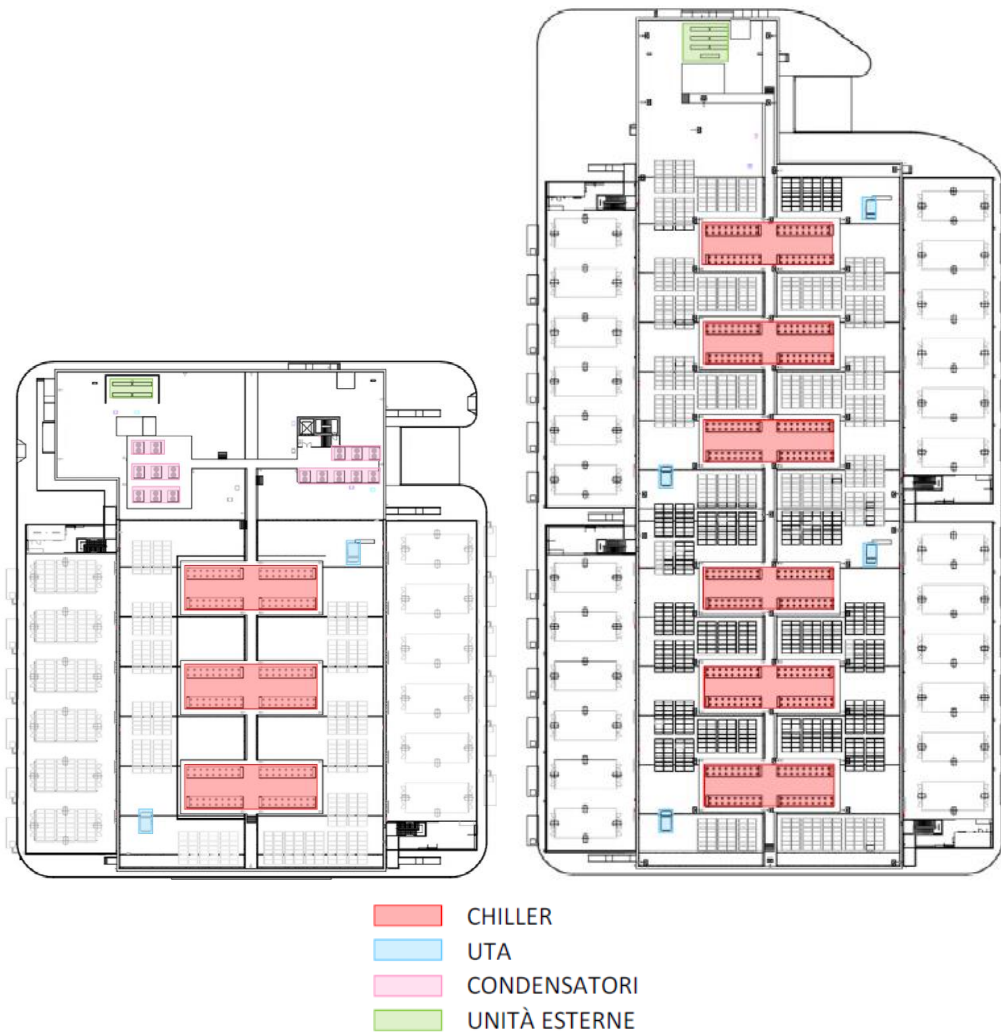
Figura 26: Distribuzione delle macchine considerate all’interno dello studio acustico – a sinistra l’edificio A1 e a destra l’edificio A2
