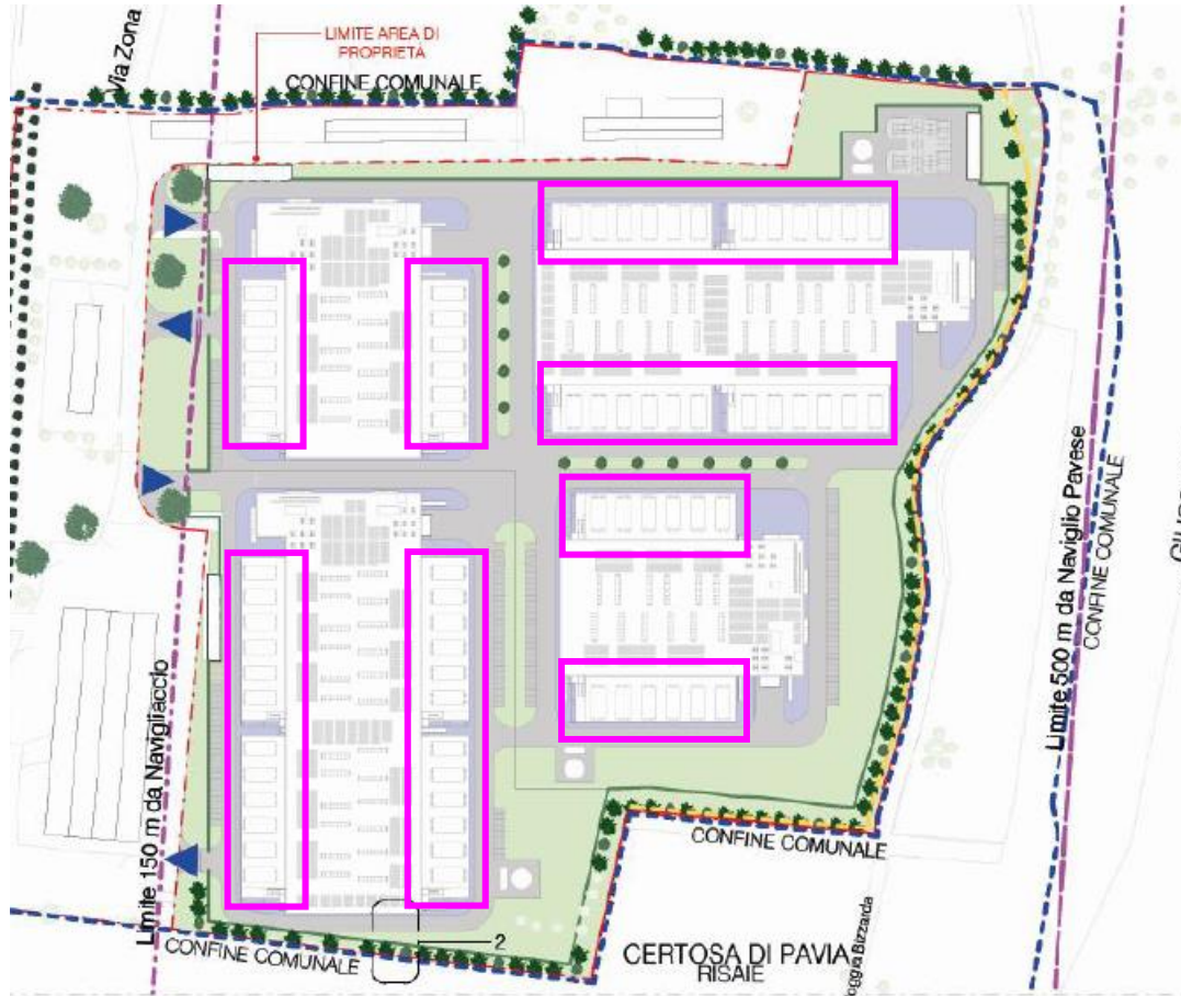
Figura 7: Ubicazione gruppi elettrogeni di emergenza
