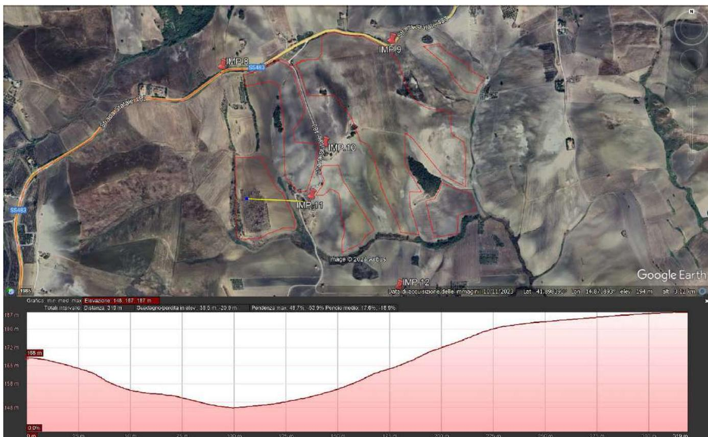
Fig. 56 Punto di presa n. 11.e sezione illustrativa della morfologia del terreno
