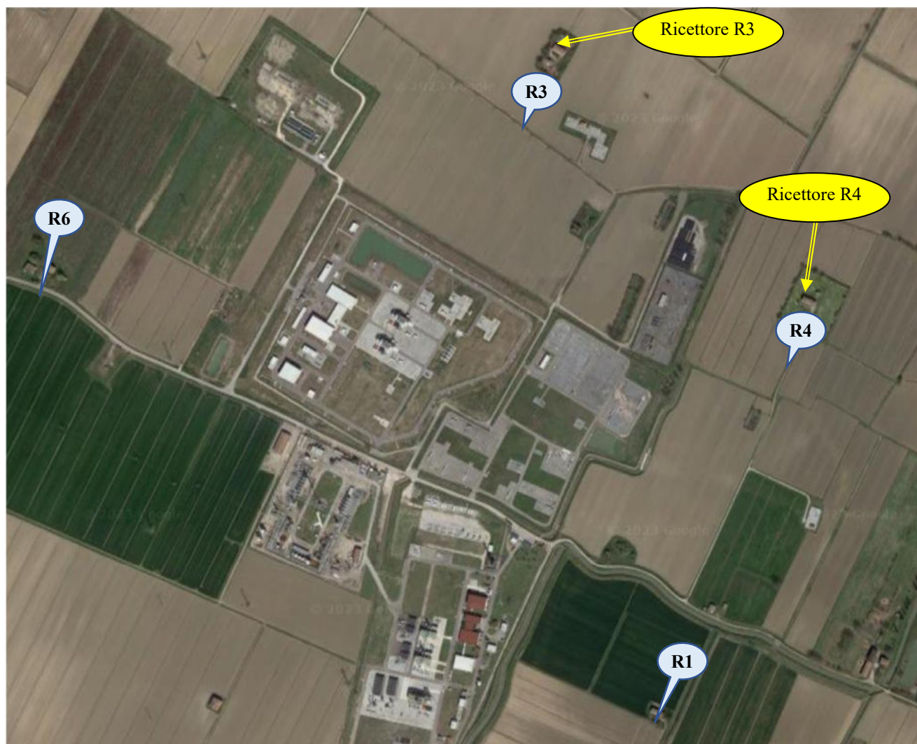
Figura 3. Foto satellitare con indicazione dei punti di misura ai ricettori
