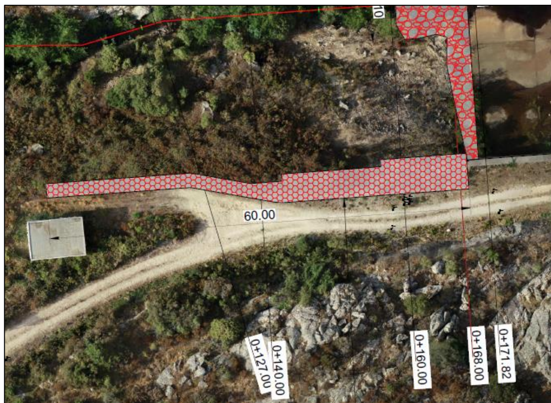
Figura 27 - Intervento con gabbioni metallici
