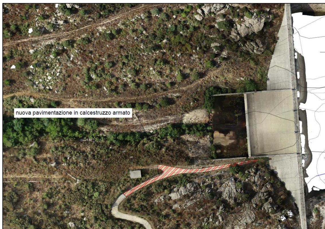
Figura 31 - Planimetria strada accesso al piede diga
