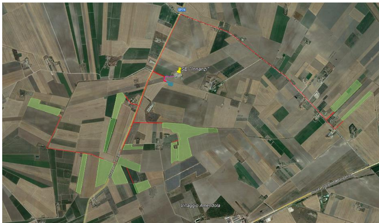
Figura 4.8: In rosso il percorso di connessione dal campo FV alla stazione elettrica.
