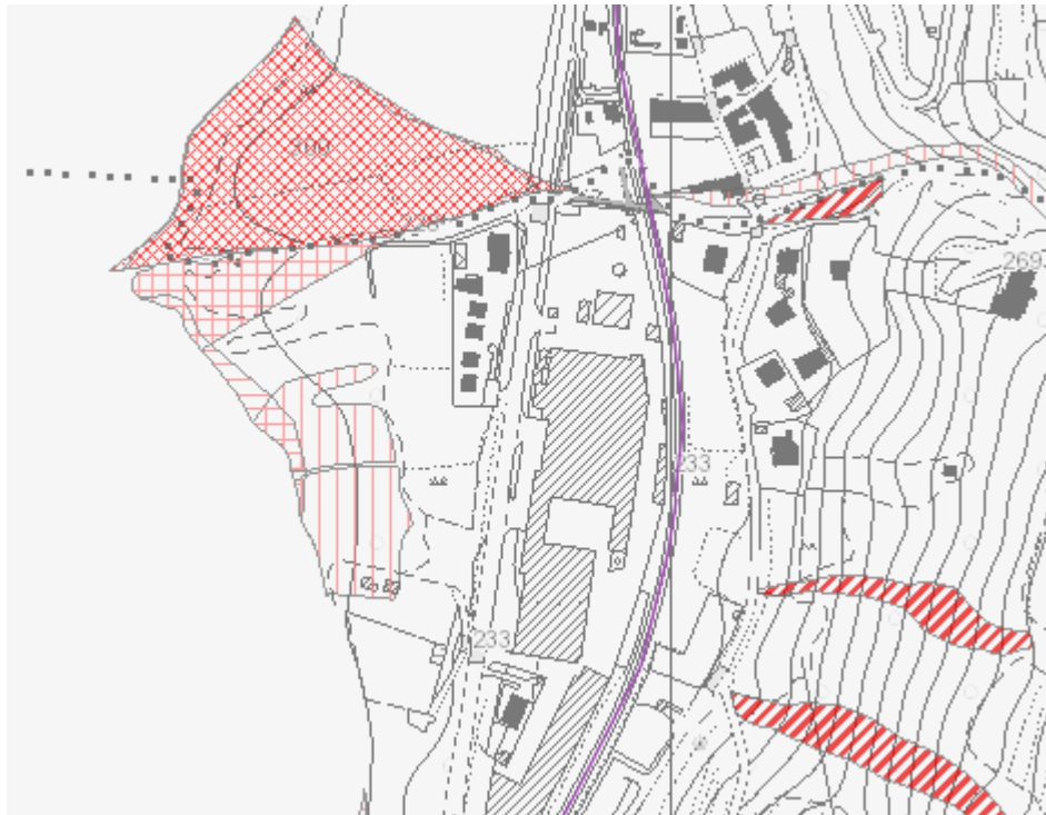
Figura 8-5 – Stralcio della cartografia PAI vigente dei dissesti, scala 5.000. In viola è indicata la linea ferroviaria.
