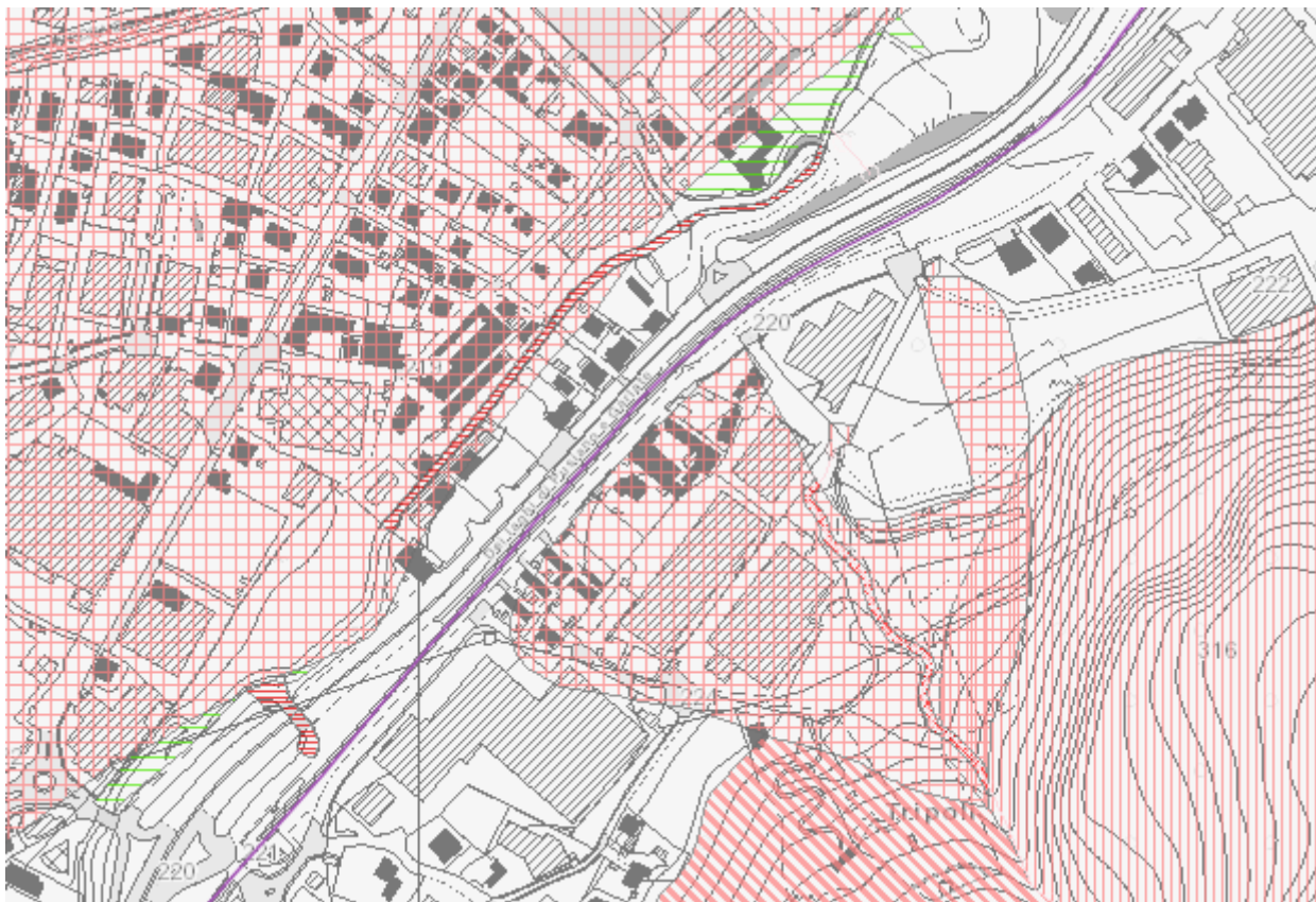
Figura 8-7 – Stralcio della cartografia PAI vigente dei dissesti, scala 10.000. In viola è indicata la linea ferroviaria.
