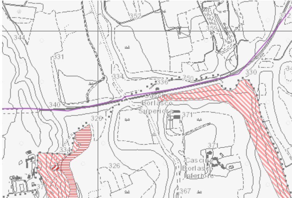
Figura 8-2 – Stralcio della cartografia PAI vigente dei dissesti, scala 5.000. In viola è indicata la linea ferroviaria.
