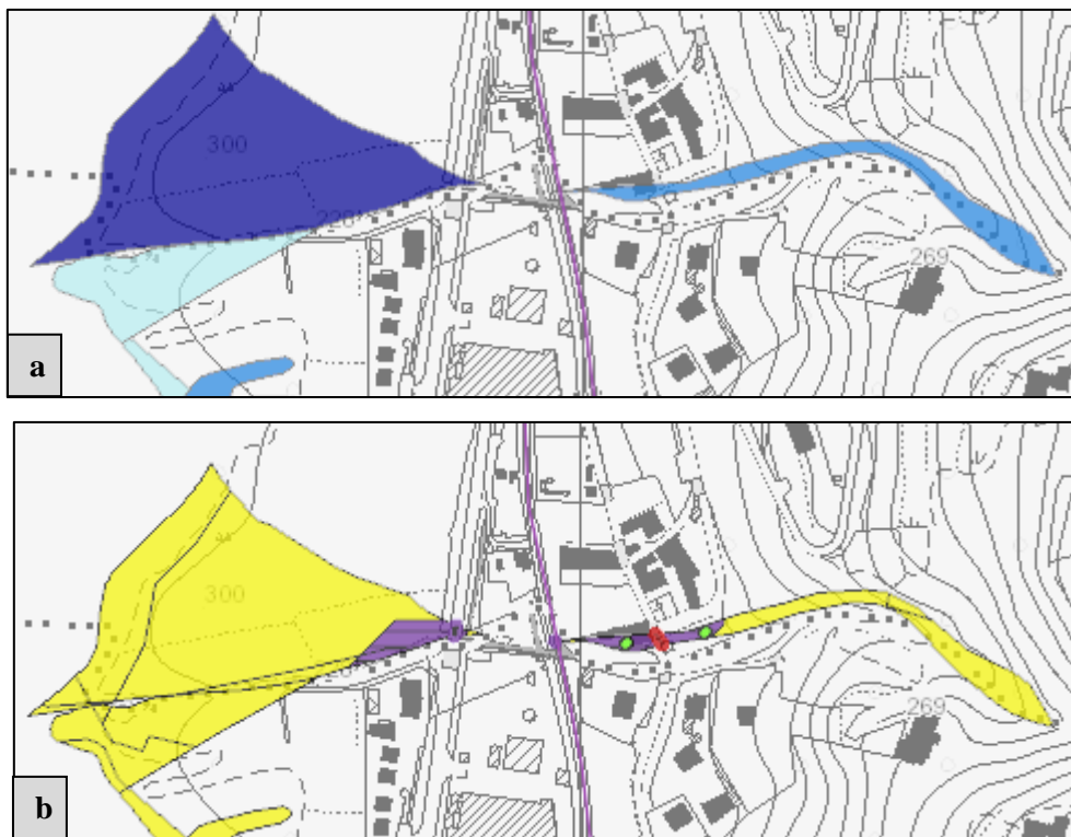
Figura 8-21 – Carta delle fasce fluviali del PAI e della pericolosità (a) e del rischio (b) da alluvione del Piano di Gestione del Rischio Alluvioni (PGRA aggiornato 2020) e della su CTR Regionale, scala 5.000. In viola è indicata la linea ferroviaria. Ubicazione: località Rossa.
