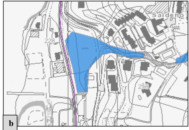
Figura 8-22 – Carta delle fasce fluviali del PAI e della pericolosità (a) e del rischio (b) da alluvione del Piano di Gestione del Rischio Alluvioni (PGRA aggiornato 2020) e della su CTR Regionale, scala 5.000. In viola è indicata la linea ferroviaria. Ubicazione: località Saidena.
