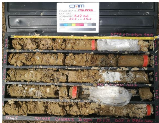
Figura 14: Formazione BOF - Immagine cassetta da Sondaggio S12 GA
