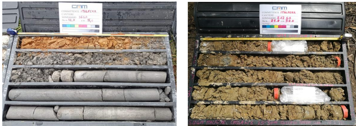
Figura 4: Ghiaia in matrice sabbiosa-limosa poggiante sul substrato roccioso nei fori dei sondaggi (a sinistra) S6 GA (in corrispondenza della galleria Montecastello) e (a destra) S12 GA (in corrispondenza della galleria Colle del Terrò)
