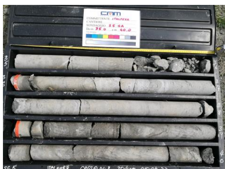
Figura 22: Formazione Peliti di Prestino (RSI) sondaggio S2 GA (sopra) e Sondaggi S5 e S6 GA (sotto)
