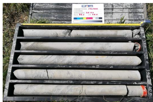
Figura 22: Formazione Peliti di Prestino (RSI) sondaggio S2 GA (sopra) e Sondaggi S5 e S6 GA (sotto)
