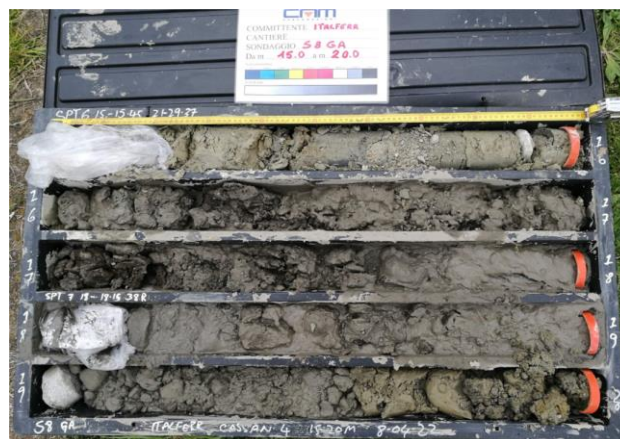
Figura 5: Intercalazione di ghiaia con limo sabbiosa e argillosa di colore grigio scuro nel foro di sondaggio S8 GA (in corrispondenza della galleria Montressone)
