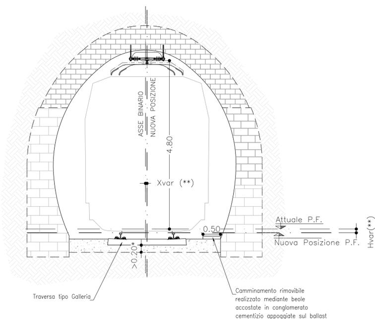
(\*\*) L'ABBASSAMENTO DEL PIANO DEL FERRO E L'EVENTUALE SPOSTAMENTO LATERALE DEL BINARIO SONO DA INTENDERSI VARIABILI SEZIONE PER SEZIONE.
