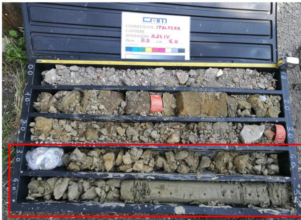
*Figura 8: Foto del materiale in cassetta del sondaggio S24 – Unità P.*
