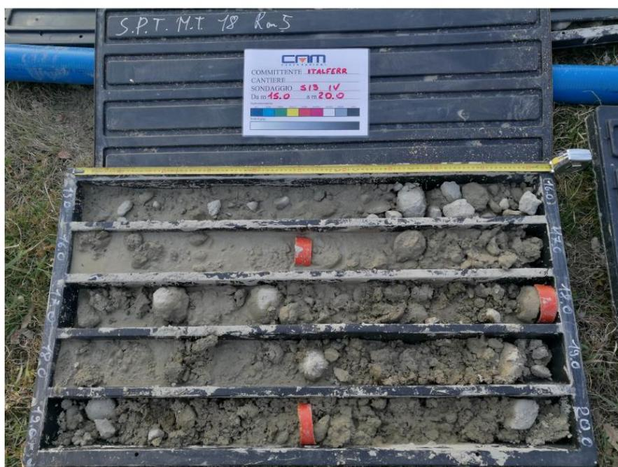
Figura 22: Foto del materiale in cassetta del sondaggio S13 – Unità B.
