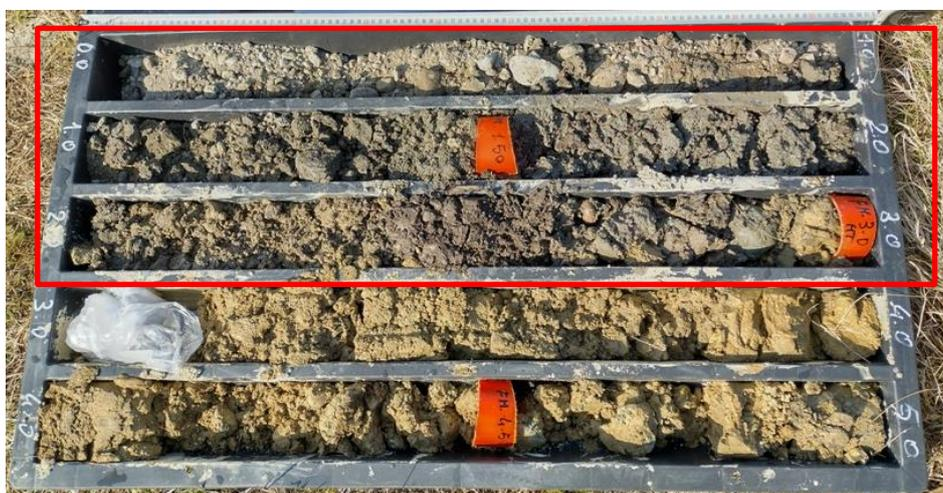
Figura 5: Foto del materiale in cassetta del sondaggio S7 – Unità R.
