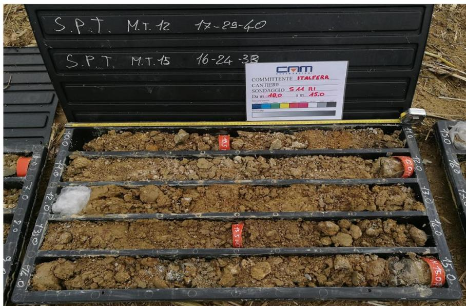
Figura 29: Foto del materiale in cassetta del sondaggio S11 – Unità CF.
