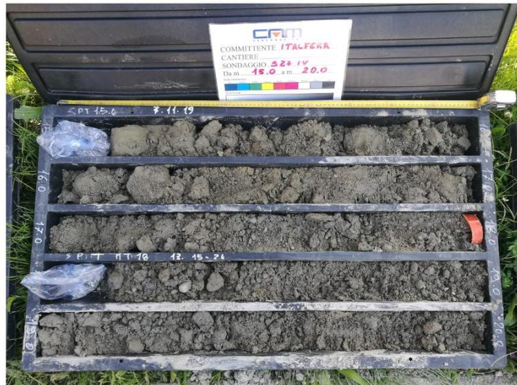
**Figura 38: Foto del materiale in cassetta del sondaggio S27 – Unità SG.**
