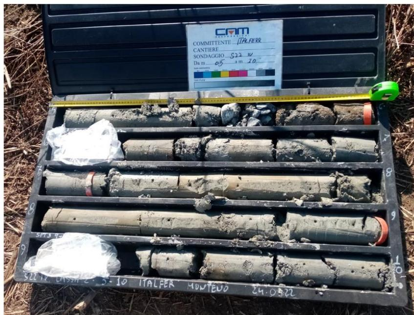
Figura 58: Foto del materiale in cassetta del sondaggio S22 – Unità L.
