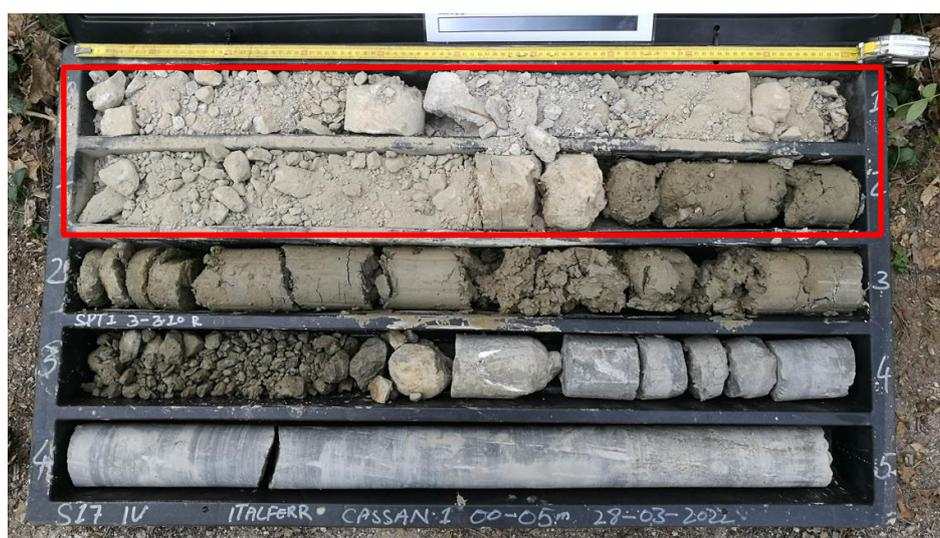
Figura 6: Foto del materiale in cassetta del sondaggio S17 – Unità R.
