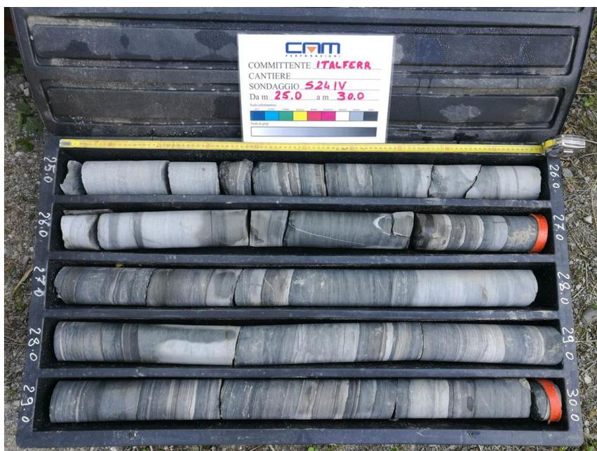
Figura 83: Foto del materiale in cassetta del sondaggio S24 – Unità SAR.
