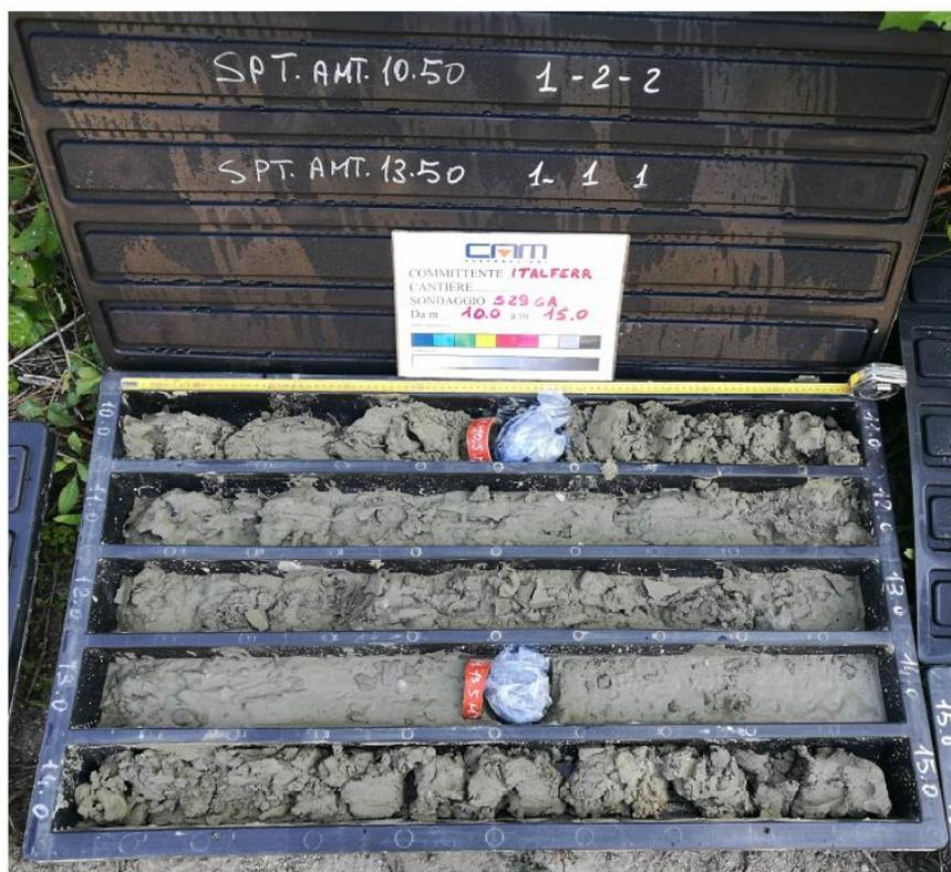
**Figura 48: Foto del materiale in cassetta del sondaggio S29 – Unità SL.**
