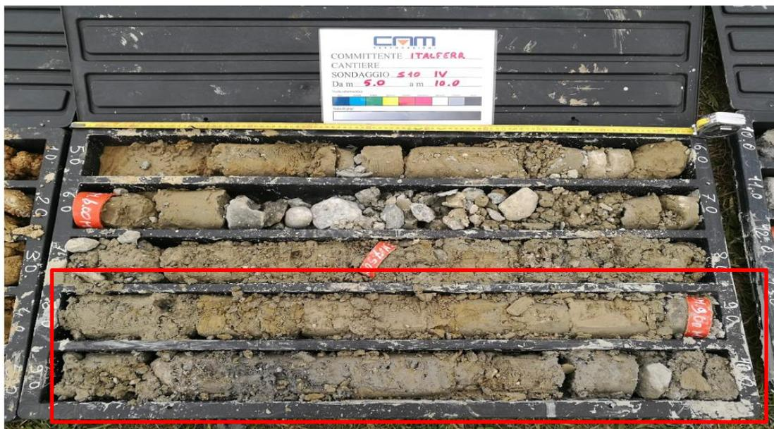
*Figura 16: Foto del materiale in cassetta del sondaggio S10 – Unità Sp.*
