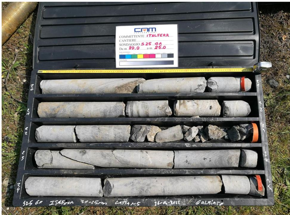
*Figura 90: Foto del materiale in cassetta del sondaggio S25 – Unità C.*
