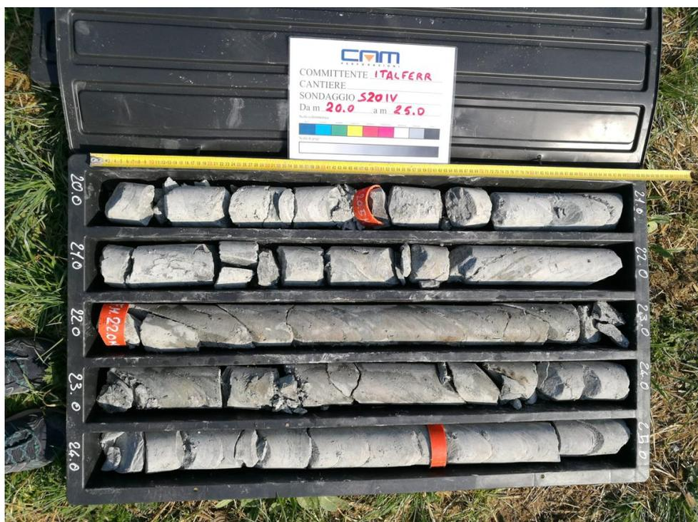
Figura 75: Foto del materiale in cassetta del sondaggio S20 – Unità FBG.
