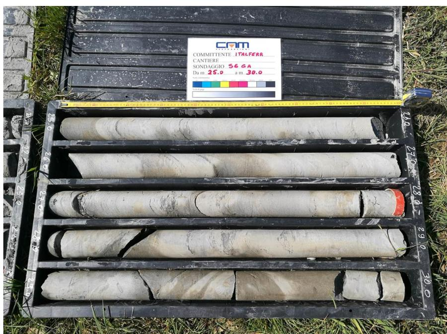
Figura 67: Foto del materiale in cassetta del sondaggio S6 – Unità AM.
