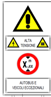
Figura 31 Tipologico segnaletica in prossimità dei PL
