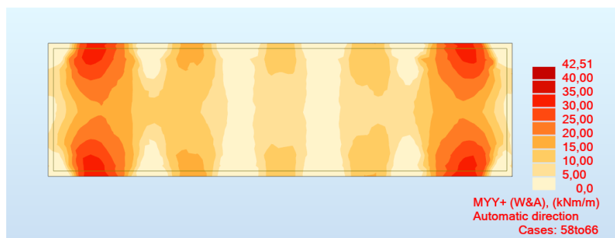
FIG. 59 – INVILUPPO SUPERIORE MOMENTO FLETTENTE (WOOD&ARMER) DIREZIONE Y
