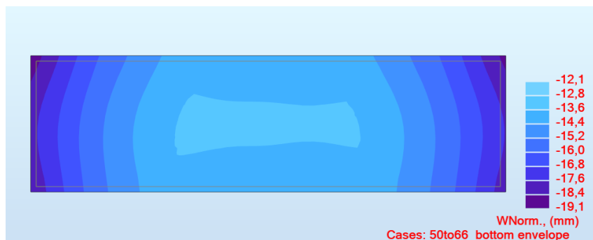
FIG.69– INVILUPPO DEI CEDIMENTI SECONDO LE COMBINAZIONI SLE – FONDAZIONE – CABINA DI INTERFACCIA
