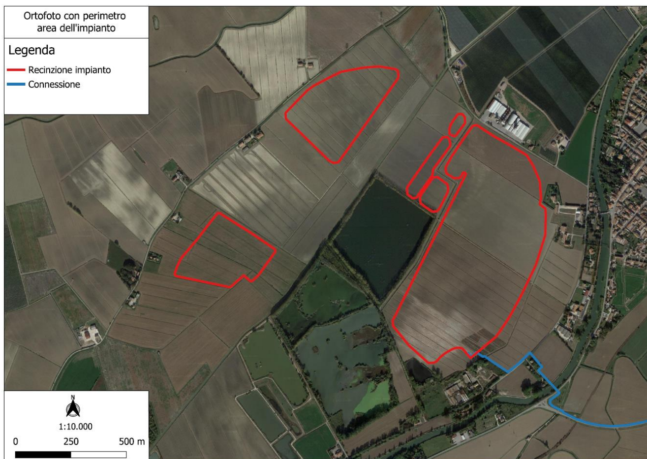
Figura 3- Ortofoto con il perimetro della recinzione dell'impianto
