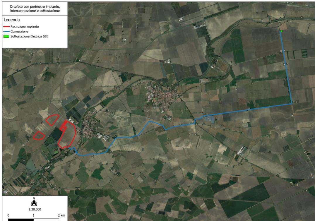
Figura 1- Ortofoto con area dell'impianto, connessione e sottostazione elettrica SSE
