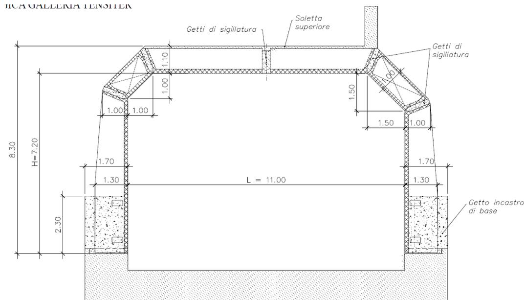
Figura 12 – Sezione tipo dell'impalcato della galleria artificiale.
