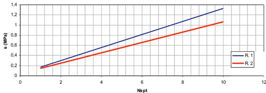
Figura 21 - Abaco per la determinazione di  $s$  per rocce alterate e fratturate.
