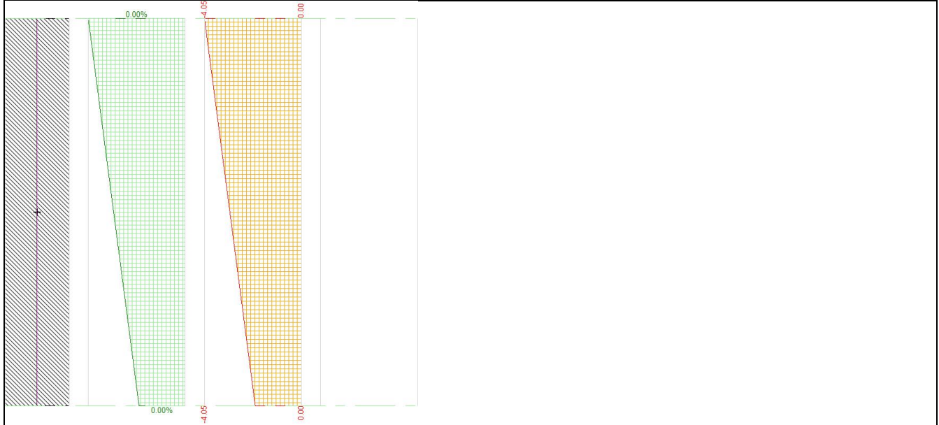
Verifica a pressoflessione, sezione del fusto, Caso 1 - SLU A1+M1+R3, z = -1 380[cm] Diagramma verde = deformazione [%], arancio = tensioni muratura [daN/cm2].
