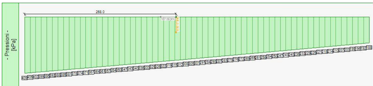
Pressioni sul terreno, per il Caso 1 ( STR [ SLU ] - SLU A1+M1+R3 )
