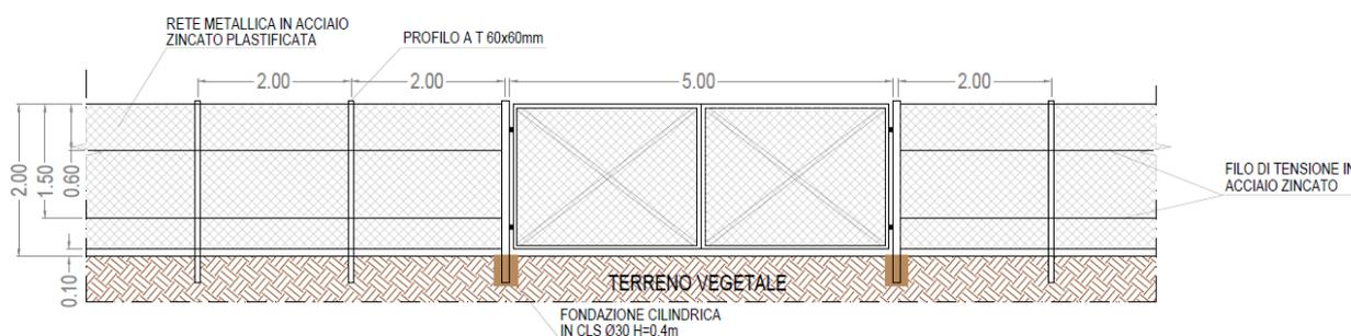
La recinzione perimetrale sarà costituita da una rete metallica in acciaio zincato, plastificata e di colore verde, mantenuta in tensione da fili in acciaio zincato posizionati lungo le estremità superiore e inferiore.
