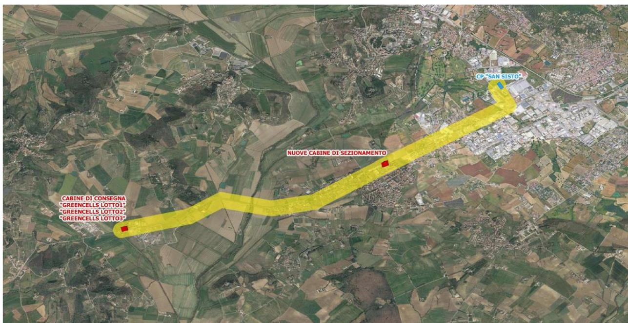
Figura 4 – Inquadramento delle opere di connessione su ortofoto estratto dall'STMG (Soluzione Tecnica Minima Generale) proposta da E-Distribuzione
