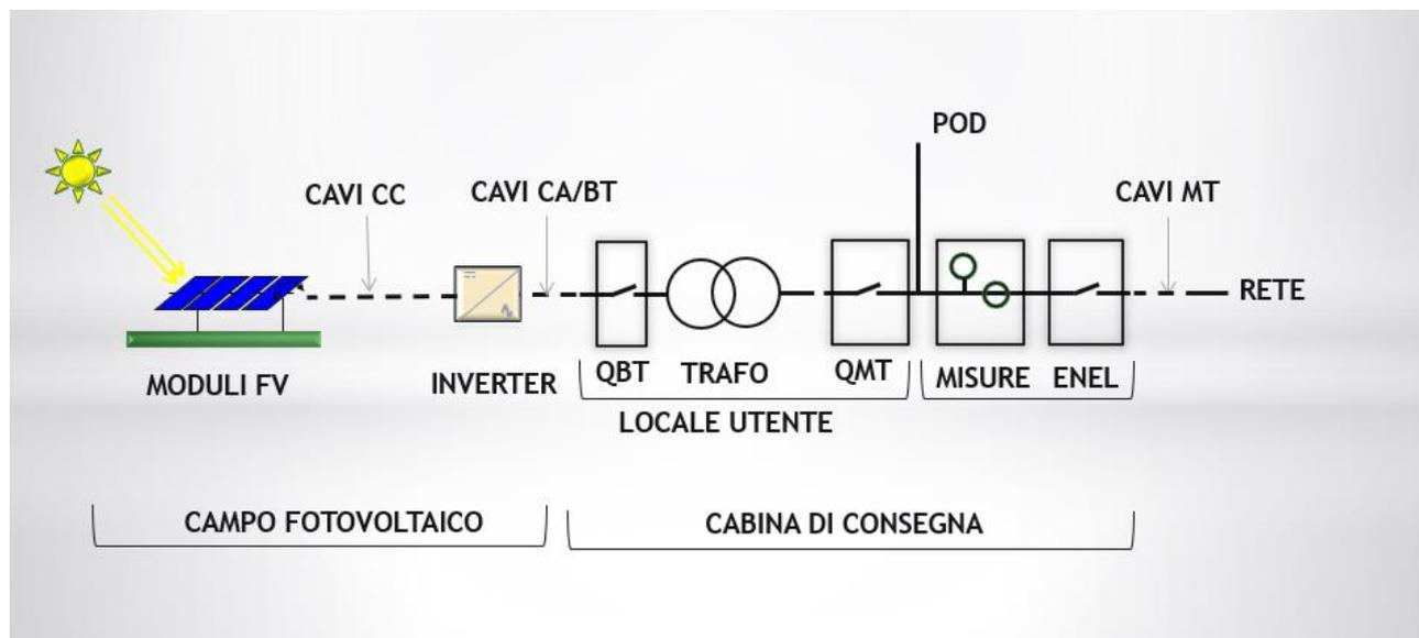
L'impianto FV ha la capacità di generare energia elettrica dai Moduli FV: ogni singolo Modulo FV trasforma l'irraggiamento solare in energia elettrica, generata in forma di corrente continua.
