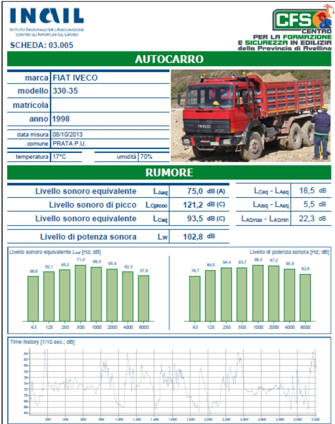
Figura 24 - Scheda tecnica (autocarro)
