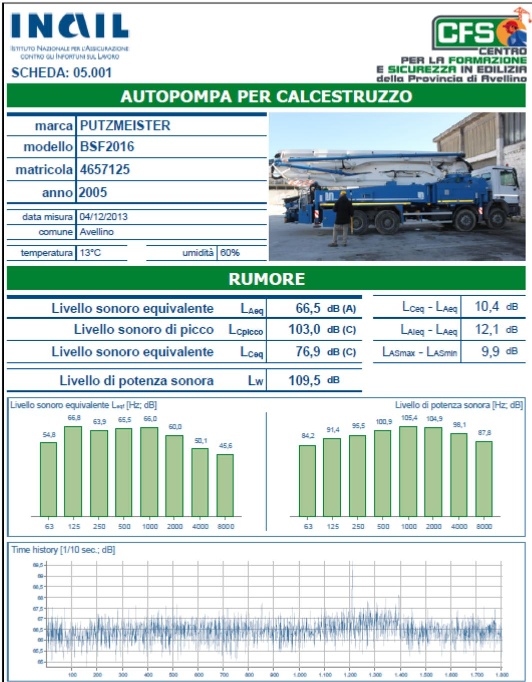
Figura 26 - Scheda tecnica (autopompa)
