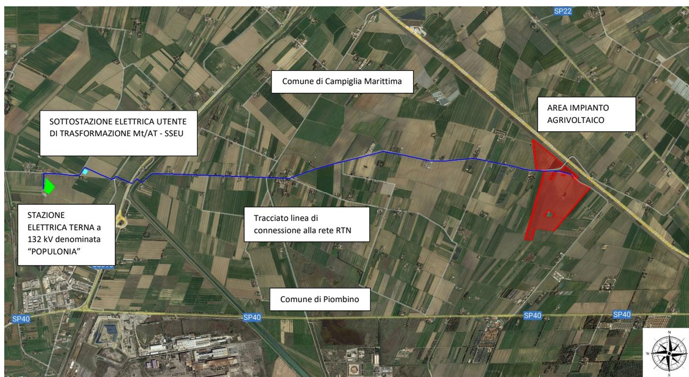
Figura 4 - Inquadramento progetto e linea di connessione su ortofoto
