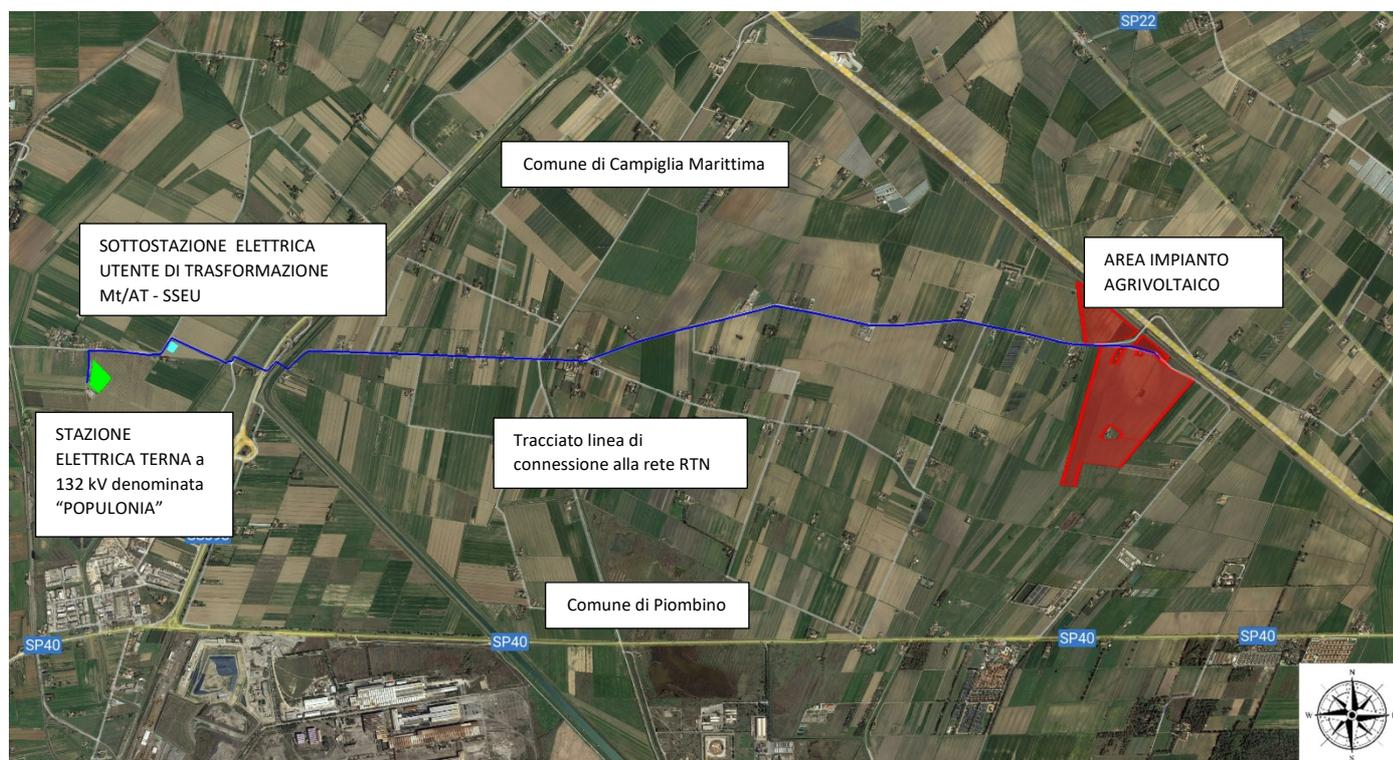
Figura 2 - Inquadramento progetto e linea di connessione su ortofoto
