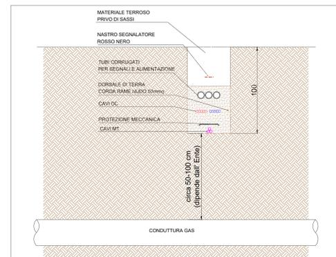
Interferenze con condutture gas/metano - sezione tipo (esterno al campo agrivoltaco)
