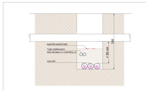
Interferenze con condutture gas/metano - sezione tipo (interno al campo agrivoltaco)
