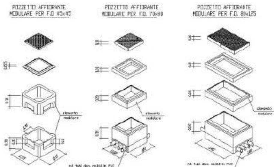
Figura 6 - Tipologia pozzetti
