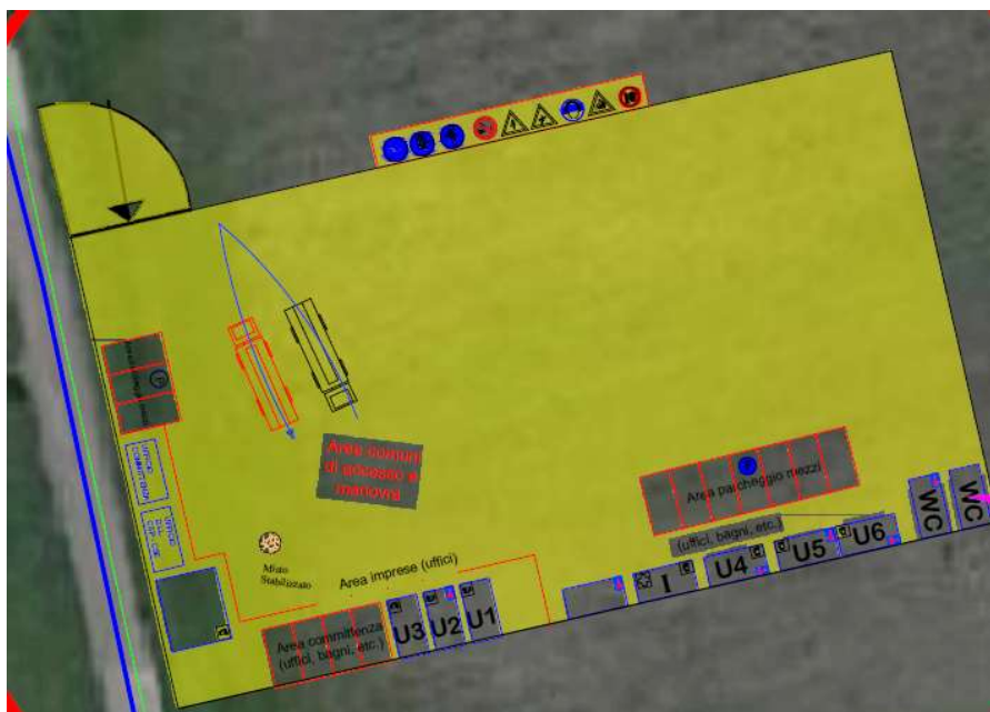
Fig. 20 Campo Base dell'Area di Cantiere [Dim. 70x40 m] e suo allestimento previsto: WC; Uffici (U); Aree di parcheggio; Sala Riunione Informazioni (I); etc.
