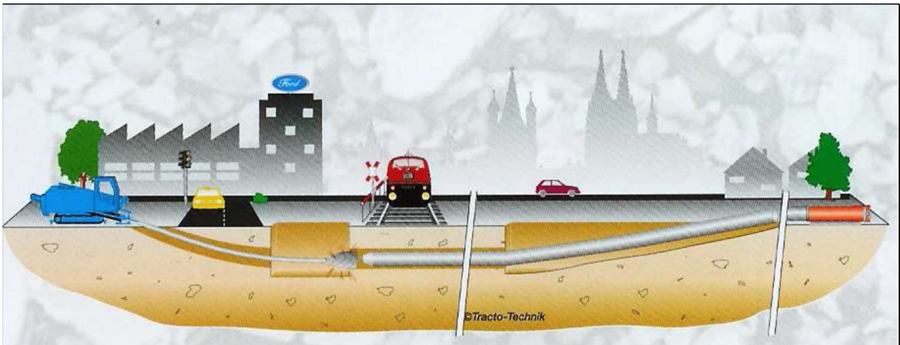
Fig. 28. Schema di principio dell'attraversamento in T.O.C.
