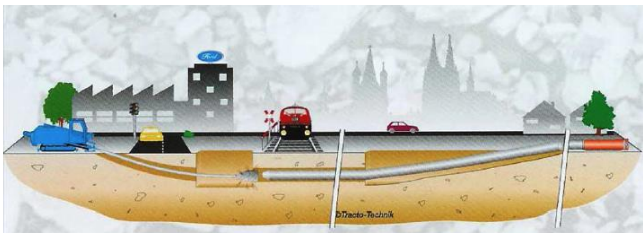
Figura 10. Schema di principio dell'attraversamento in T.O.C.
