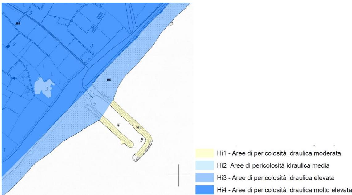
**Figura 9 – aree a pericolosità idraulica nella bocca a mare di Su Portu**
