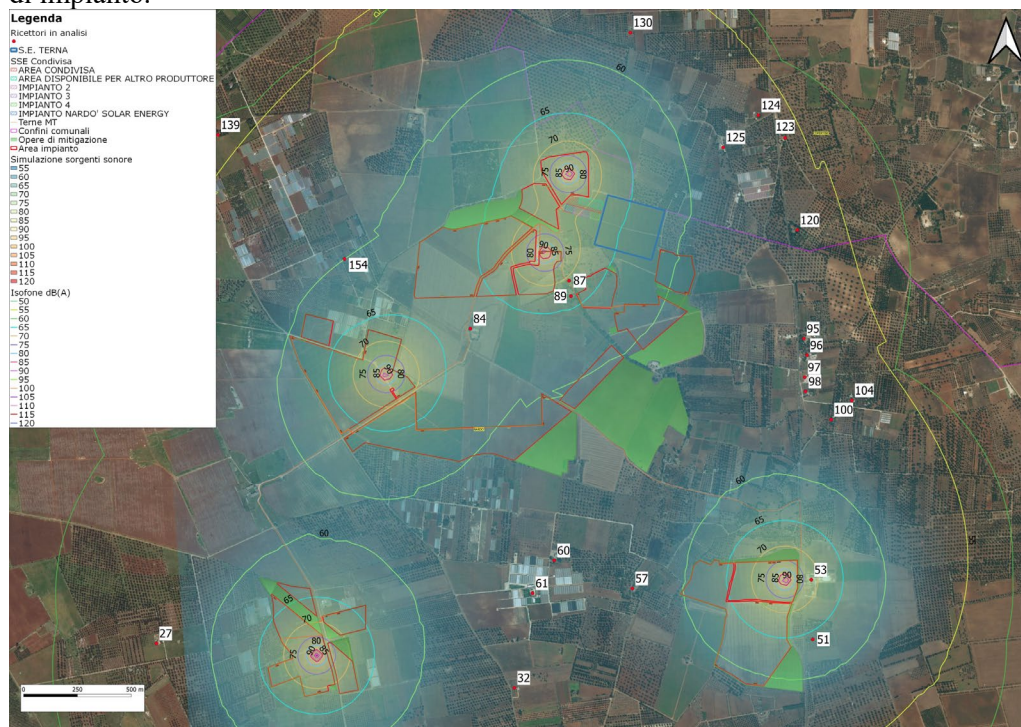
Fig. 27: Rumore prodotto in fase di cantiere – Isofone e ricettori
