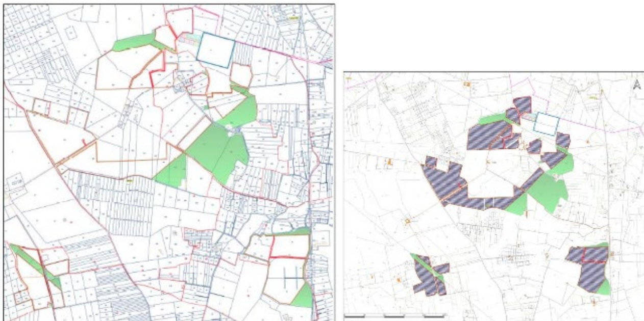
Fig.4: Layout impianto con in verde opere mitigazione e in rosso recinzioni impianto
