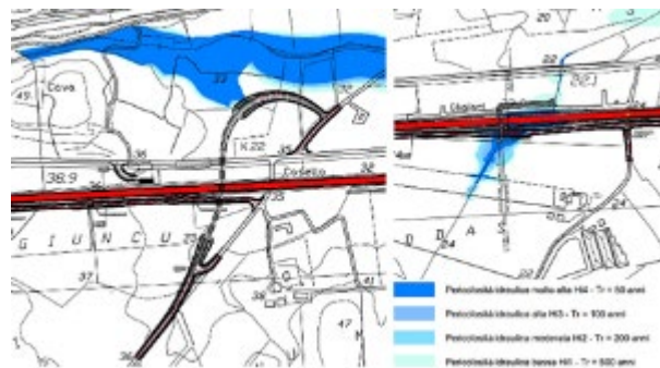
Figura 26: Aree a pericolosità idraulica perimetrate dal PGRA
