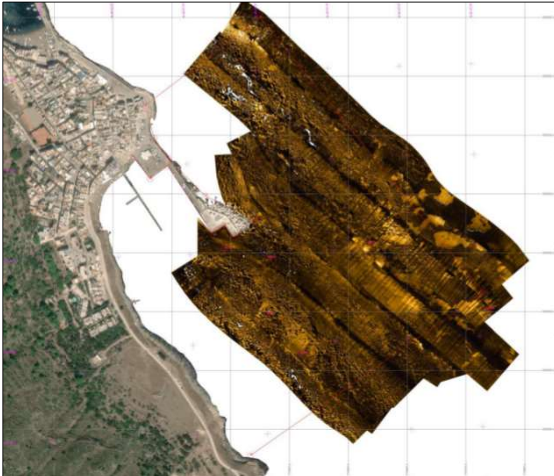
Fig. 3.16 - Fotomosaico area di indagine ottenuto tramite Side Scan Sonar.
