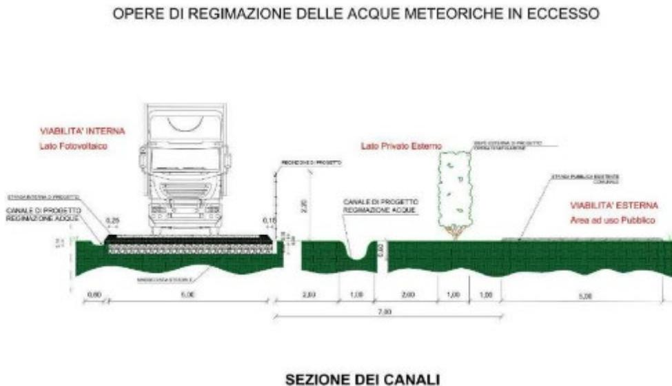
Figura 14. Opere di regimazione delle acque meteoriche in eccesso
