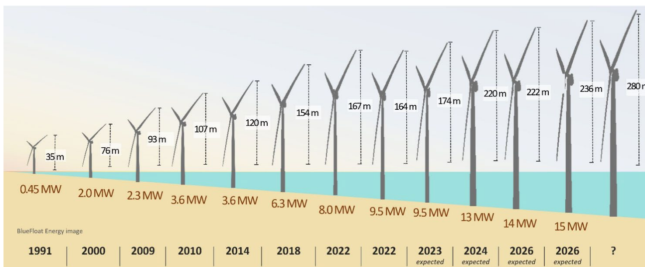
Figura 53: Evoluzione delle turbine eoliche offshore, con indicazione della potenza nominale unitaria della turbina [MW], del diametro del rotore [m] e dell'anno di entrata in funzione del parco eolico, BlueFloat Energy.
