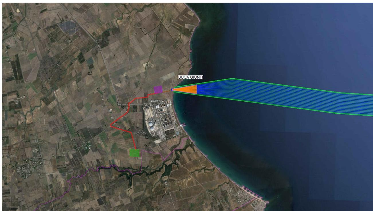
**Figura 2: Punto di approdo e connessione tra la parte onshore ed offshore – in rosso il cavidotto onshore.**
