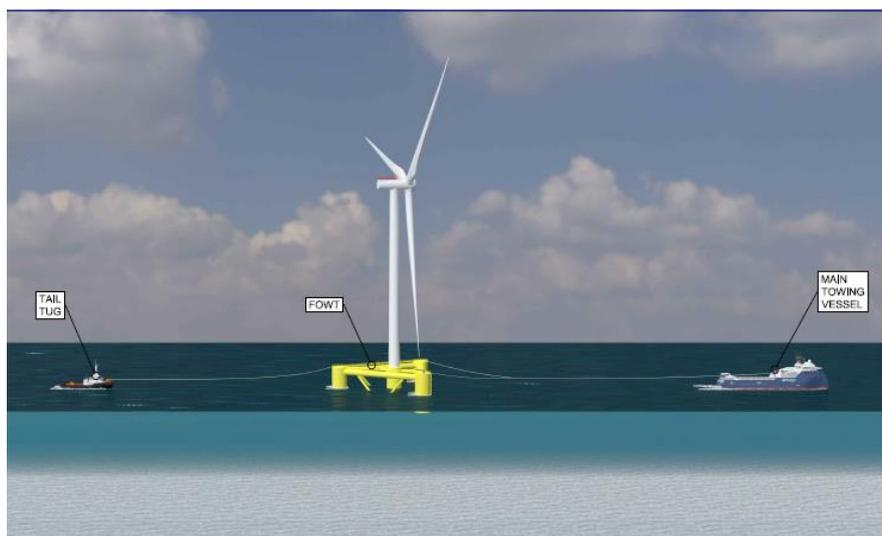
**Figura 3: Configurazione di traino.**
