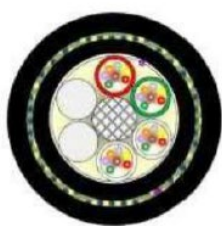
Figura 9: Sezione cavo con 48 fibre ottiche
