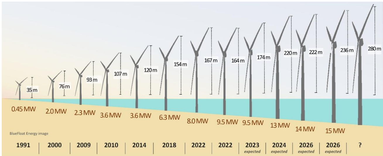
Figura 12: Evoluzione delle turbine eoliche offshore, con indicazione della potenza nominale unitaria della turbina [MW], del diametro del rotore [m] e dell'anno di entrata in funzione del parco eolico, BlueFloat Energy.
