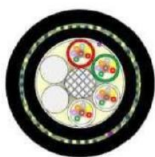
Figura 122: Sezione tipo cavo con 48 fibre ottiche.
