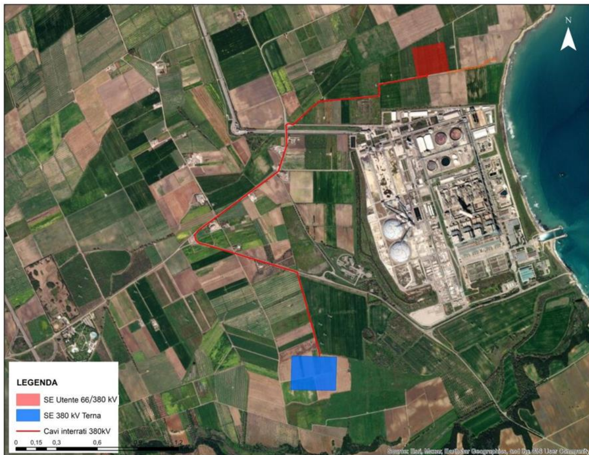
Figura 117: Cavo interrato di connessione 380 kV tra la Stazione Elettrica Utente 66/380 kV e la Stazione RTN 380 kV.
