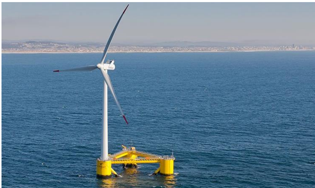
Figura 179: Esempio di fondazione galleggiante di colore giallo.
